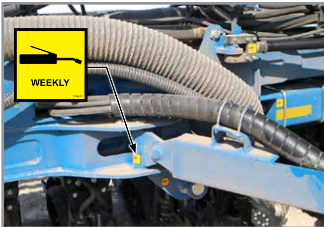
3. Draft Link, 2 per machine 1 fitting per link
