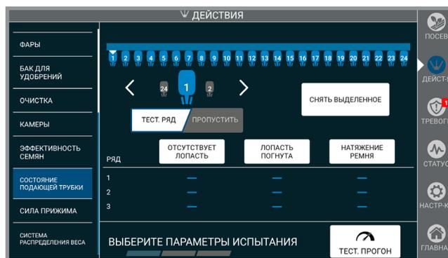
Пункт меню «Состояние подающей трубки» выполнит проверку ремней подающих трубок True Speed и определит, требуются ли какие-либо регулировки. При обнаружении неисправностей пользователь может нажать заголовки категорий, чтобы получить более подробные инструкции о том, как настроить систему.
