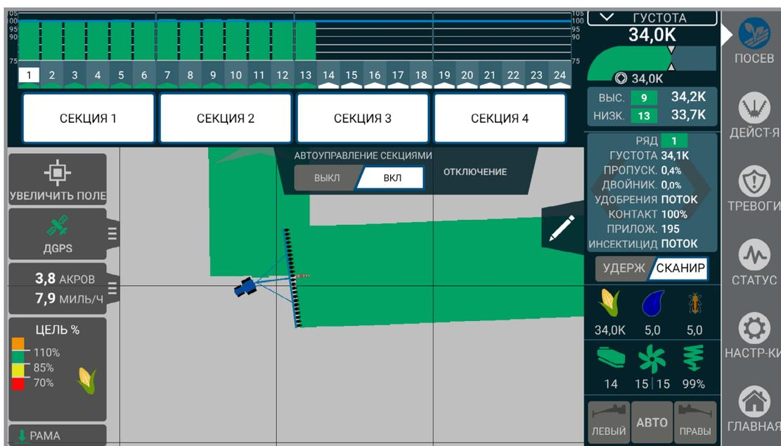
**Отключение секций.** Предоставляет возможность вручную отключить подачу семян для отдельных секций. Ручное управление всегда активно, и пользователь может на странице настроек выбрать, используется ли одна, две или четыре секции.
