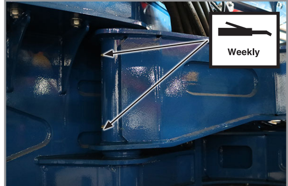
2. Fold pivot, 2 per machine 2 fittings per pivot
