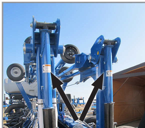
Встановлений блокувальний пристрій маркера
