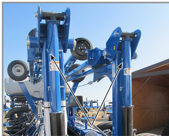
Встановлений блокувальний пристрій маркера
