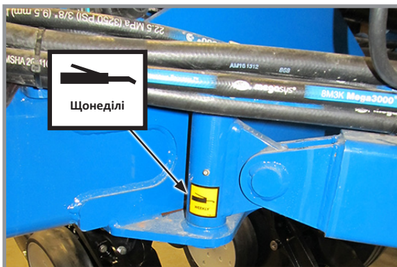
5. Направляюча тяга, по 2 на сівалку, по 1 точці змащування на модуль
