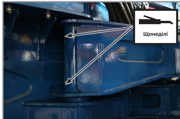
2. Поворотна ось, по 2 на сівалку, по 2 точки змащування на шарнір
