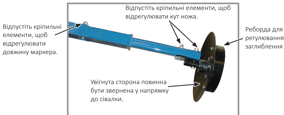
Регулювання кута дискового ножа маркера
