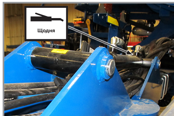
6. Циліндр притиску крила, по 2 на сівалку, по 2 точки змащування на циліндр (по одній на кожному кінці)
