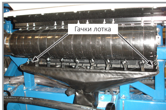
Встановлений очисний лоток
