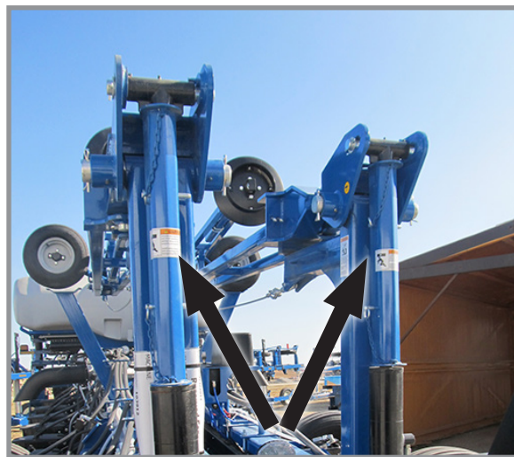
Установленное стопорное устройство маркера
