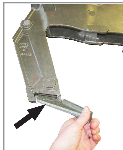
Защита семяпровода/внутренний чистик (копирующее колесо/дисковый нож сошника для внесения семян снят для большей наглядности)
