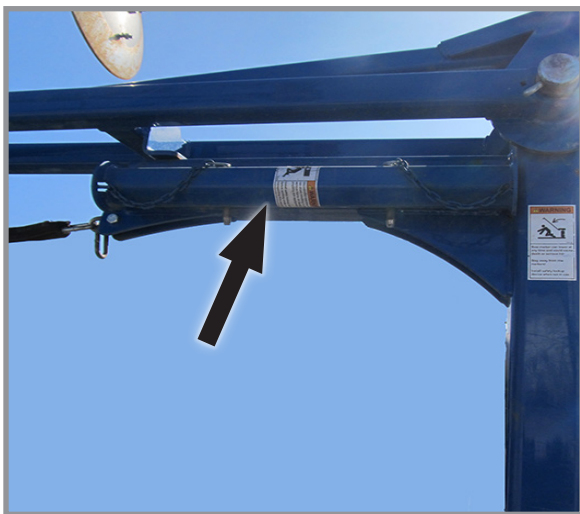
Стопорное устройство маркера в положении для хранения
