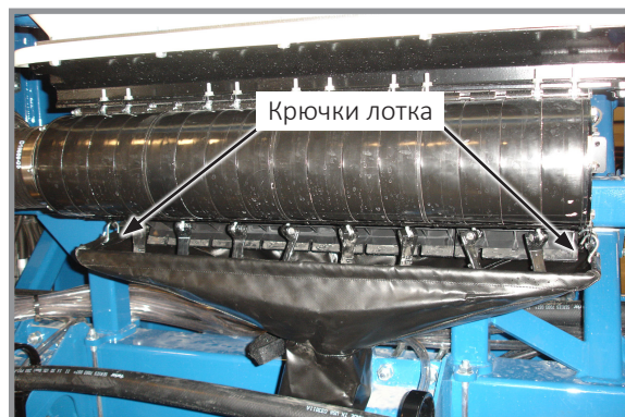
Установленный очистной лоток
