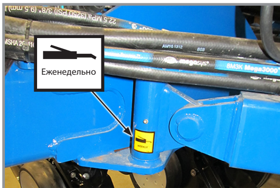
5. Направляющая тяга, по 2 на сеялку, по 1 точке смазки на модуль
