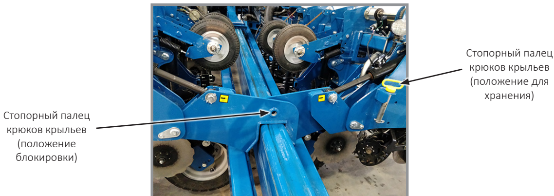
Снятие с дышла блокировки крюков крыльев
