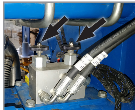
Регулировка органов управления скоростью маркеров
