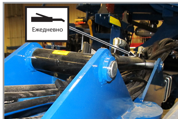
6. Цилиндр прижима крыла, по 2 на сеялку, по 2 на цилиндр. (по одной с каждого конца)
