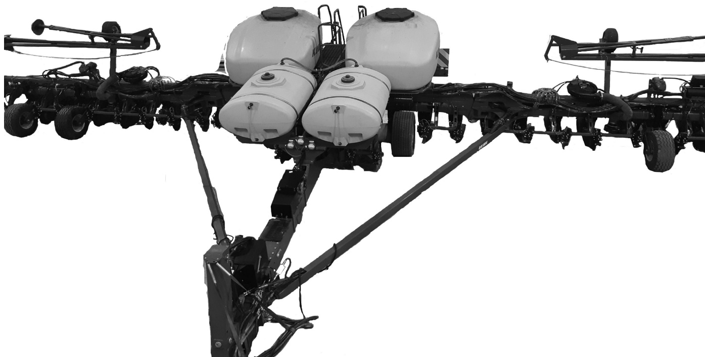
Оборудование для внесения жидких удобрений, установленное на сеялке модели 4805 с системой центральных бункеров
