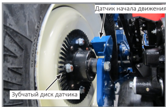
Датчик начала движения и зубчатый диск
