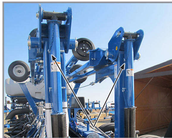
Установленное стопорное устройство маркера
