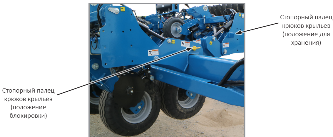
Установленная блокировка крюков крыльев
