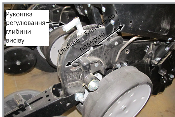
Регулювання глибини висіву
