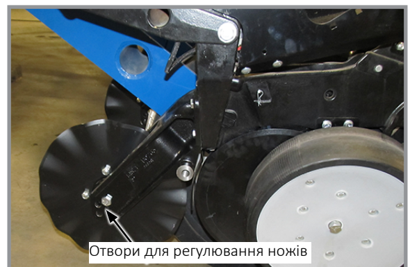
Дискові ножі для нульової обробки ґрунту, що встановлюються на висівній секції
