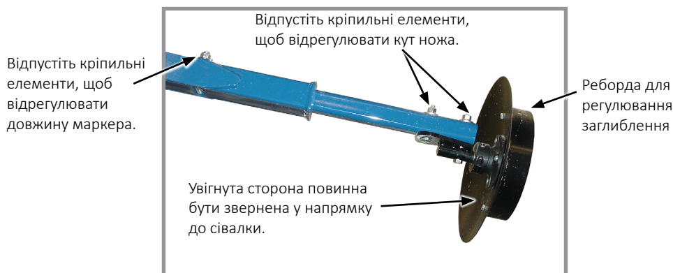
Регулювання кута дискового ножа маркера
