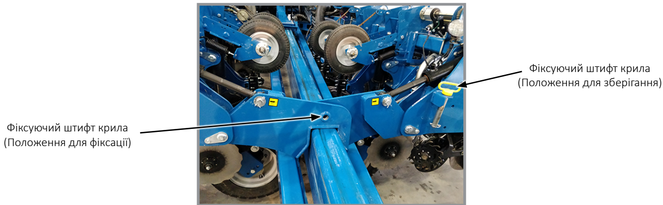
Від'єднання дишла від гаків крил
