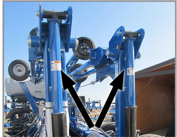
Встановлений блокувальний пристрій маркера
