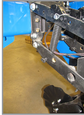
Дві пружини на ряд (подвійні пружини)
