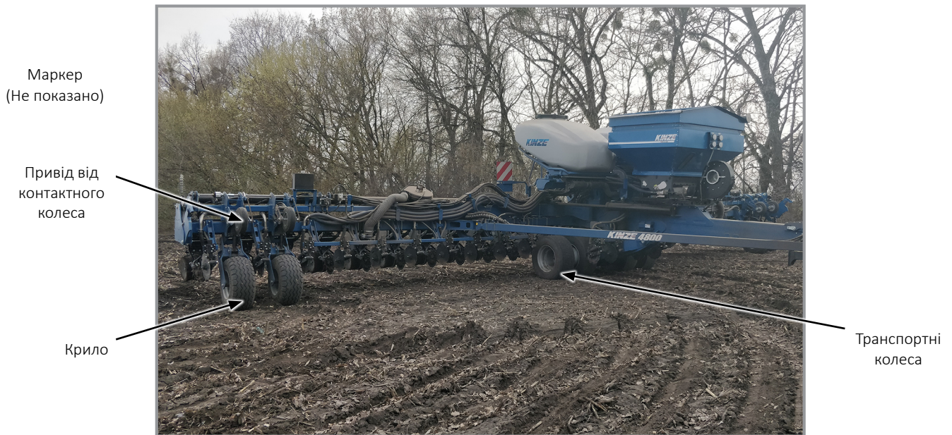
Розташування шин (показано праву сторону)
