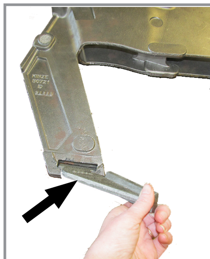
Захист насінняпроводу/внутрішній чистик (Копіююче колесо/дисковий ніж леміша для внесення насіння знятий для більшої наочності)
