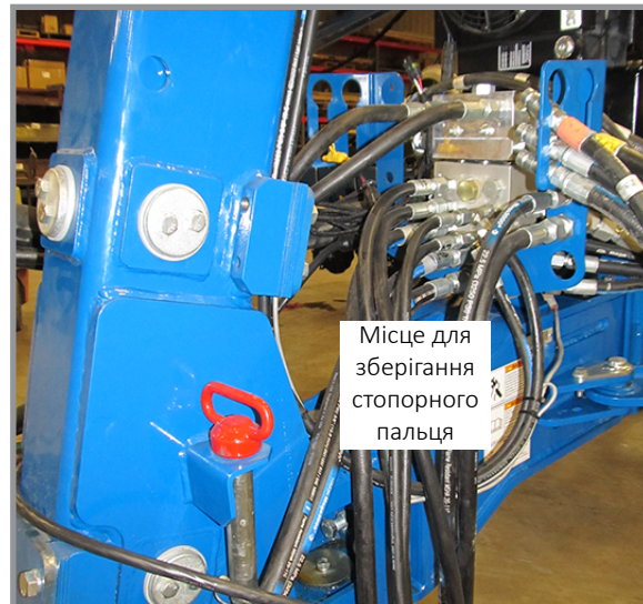
Стопорний палець зчипки дишла
