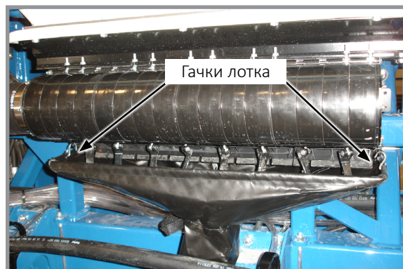
Встановлений очисний лоток
