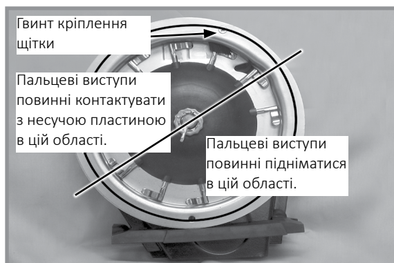
Правильна робота пальчикового висівного апарату
