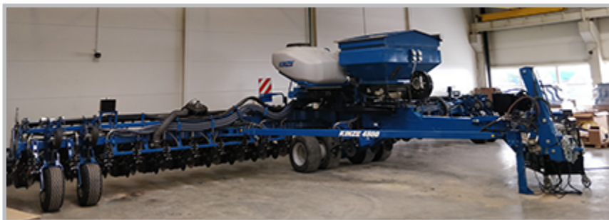
24-рядна сівалка точного висіву моделі 4800 з системою центральних бункерів
