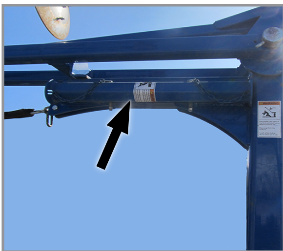
Блокувальний пристрій маркера в положенні для зберігання
