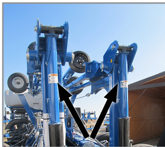
Встановлений блокувальний пристрій маркера
