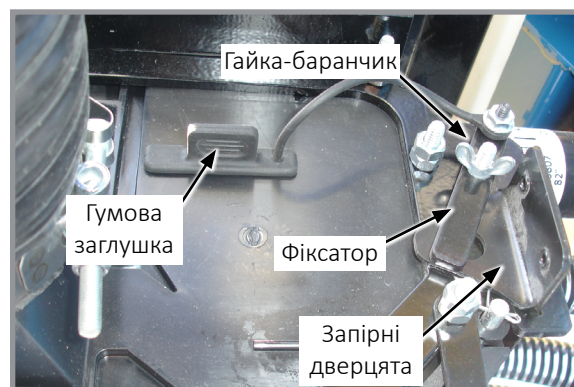
Розподільник системи центральних бункерів (вид з торця)
