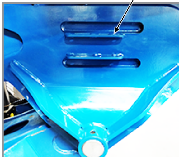
Кронштейн для зберігання блокувального пристрою циліндра
