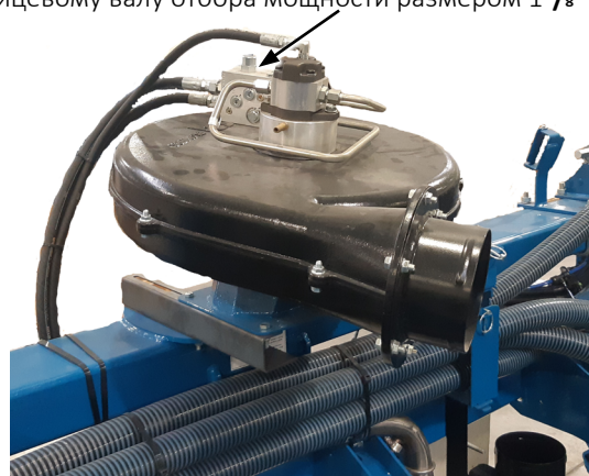
Блок вакуумного вентилятора
