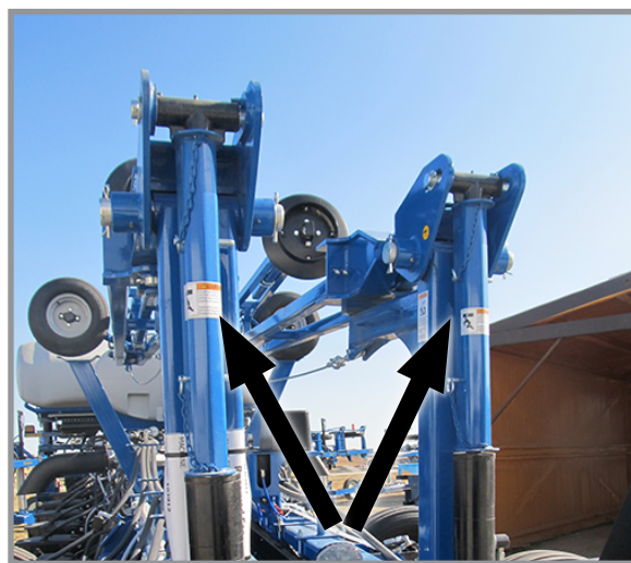
Установленное стопорное устройство маркера
