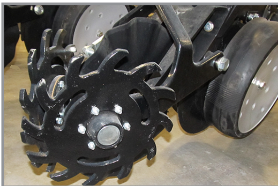
Колеса для пожнивных остатков с креплением на дисковых ножах
