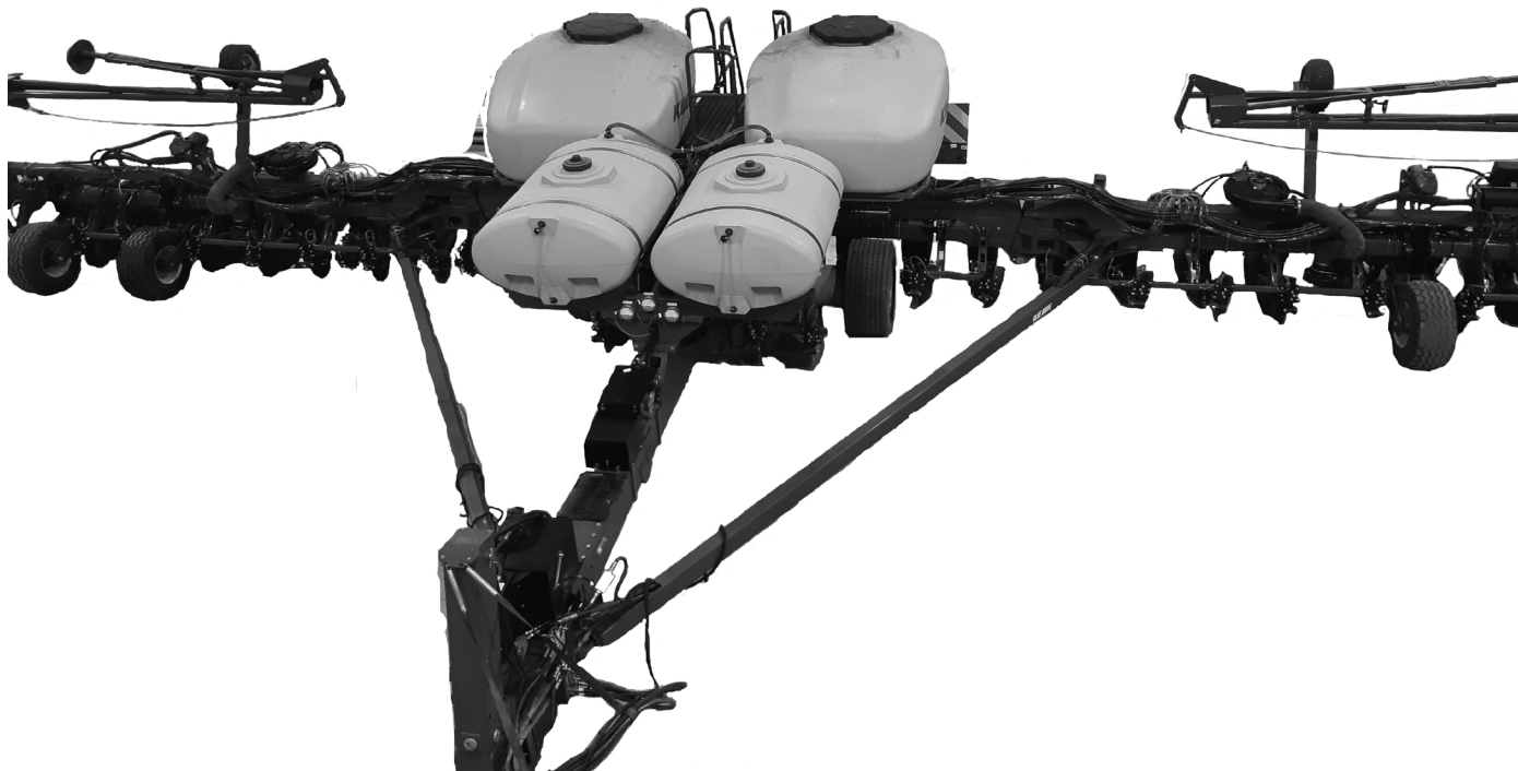
Оборудование для внесения жидких удобрений, установленное на сеялке модели 4800 с системой центральных бункеров
