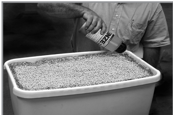
Добавление графита в стандартный бункер
