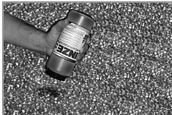
Добавление графита в центральный бункер для семян
