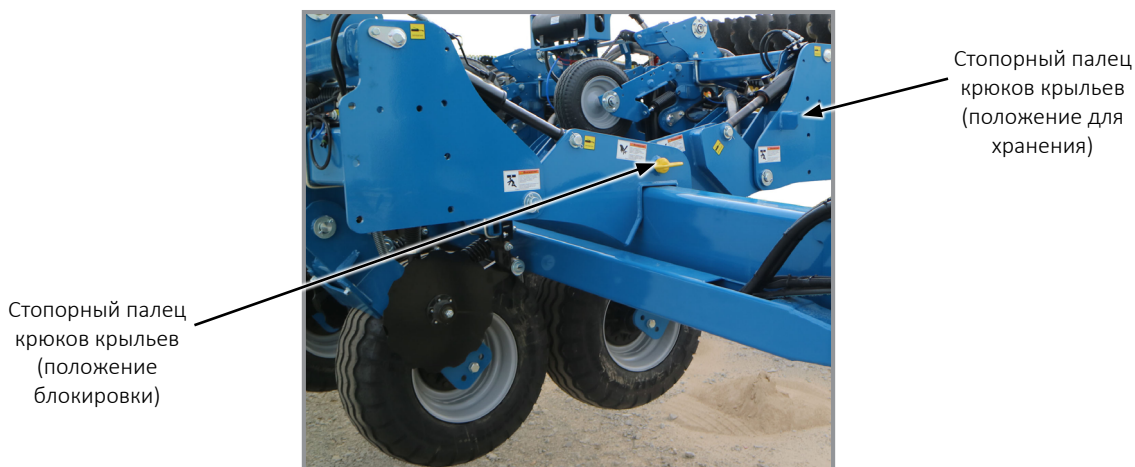
Установленная блокировка крюков крыльев
