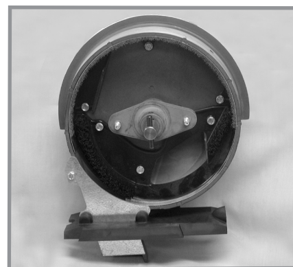
Показана сеялка без установленного высевающего диска
