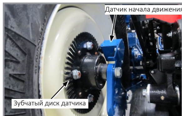
Датчик начала движения и зубчатый диск
