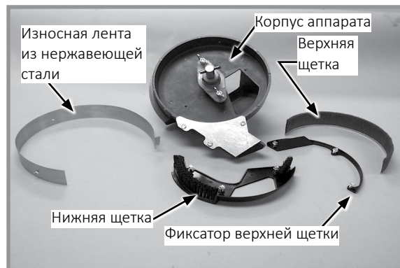
Детали щеточного высевающего аппарата
