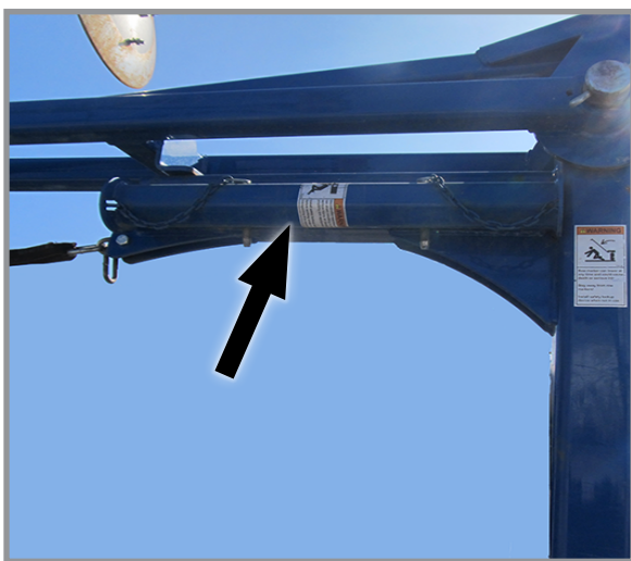
Стопорное устройство маркера в положении для хранения
