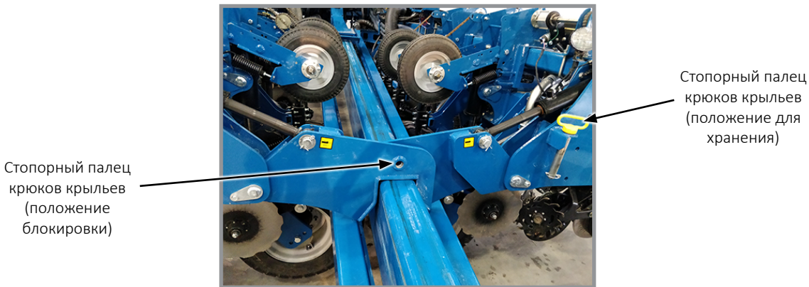
Снятие с дышла блокировки крюков крыльев
