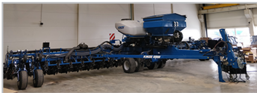
24-рядная сеялка точного высева модели 4800 с системой центральных бункеров
