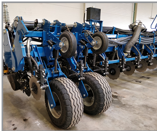
Колеса крыльев в положение для разворота в конце поля
