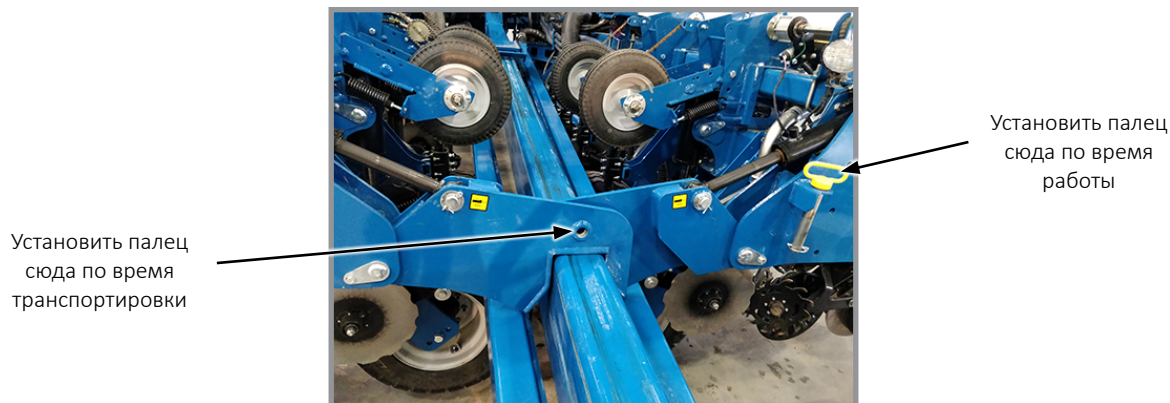
Снятие с дышла блокировки крюков крыльев
