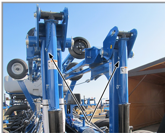
Установленное стопорное устройство маркера
