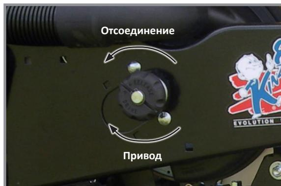
Отсоединение привода высевающего аппарата
