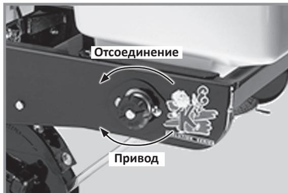
Отсоединение привода для внесения гранулированных химикатов
