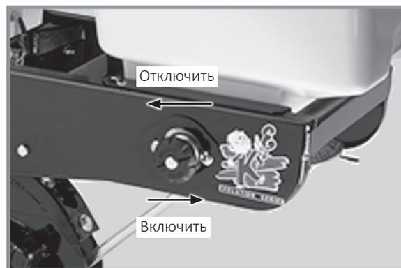
Выжимная рукоятка привода оборудования для гранулированных химикатов
