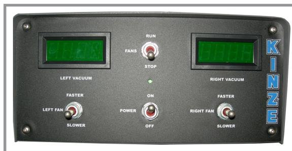
**Пульт управления вакуумной системой с цифровым индикатором**
