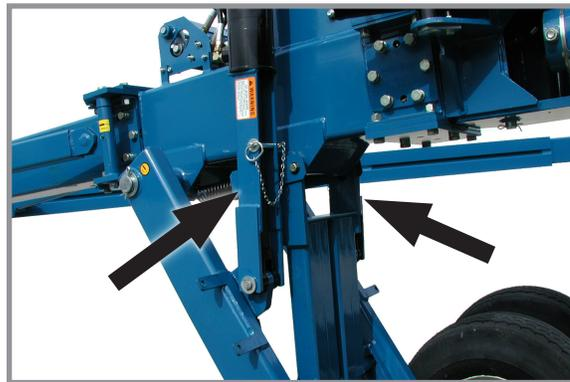
Стопорное устройство в положении для
