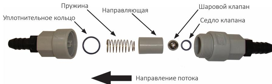
1. Разберите корпус, отвернув по резьбе, и отсоедините половины корпуса друг от друга. Отметьте ориентацию и расположение деталей.
