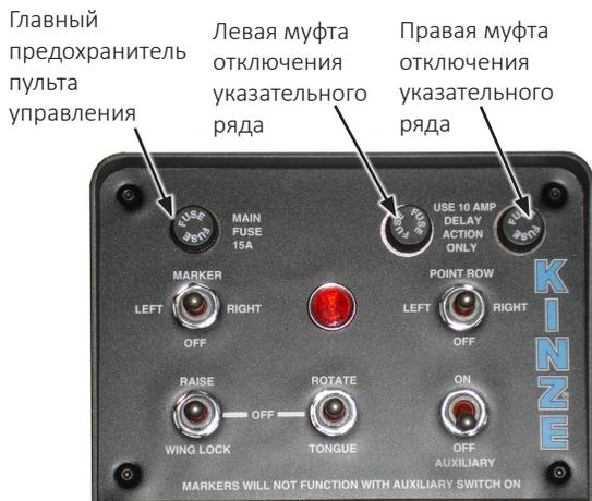
**Пульт управления односкоростной муфты отключения указательного ряда (вид спереди)**
