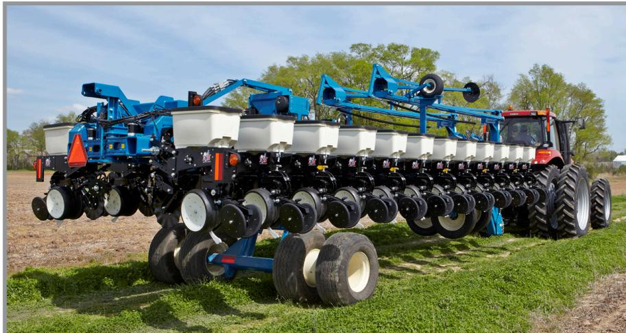
**24-рядная сеялка точного высева модели 3705 со стандартными бункерами**
