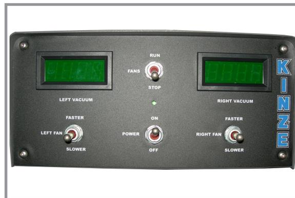
Пульт управления вакуумной системой с цифровым индикатором
