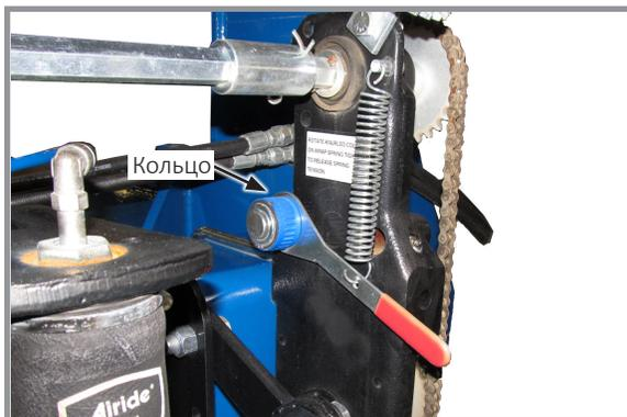
Рычаг с витой пружиной (показан левый рычаг)
