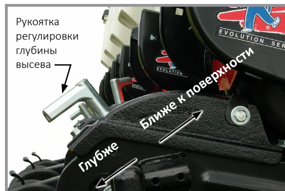
Регулировка глубины высева
