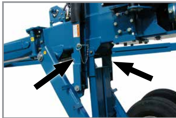
Стопорное устройство в положении для транспортировки/обслуживания
