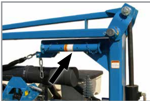
Стопорное устройство маркера не задействовано
