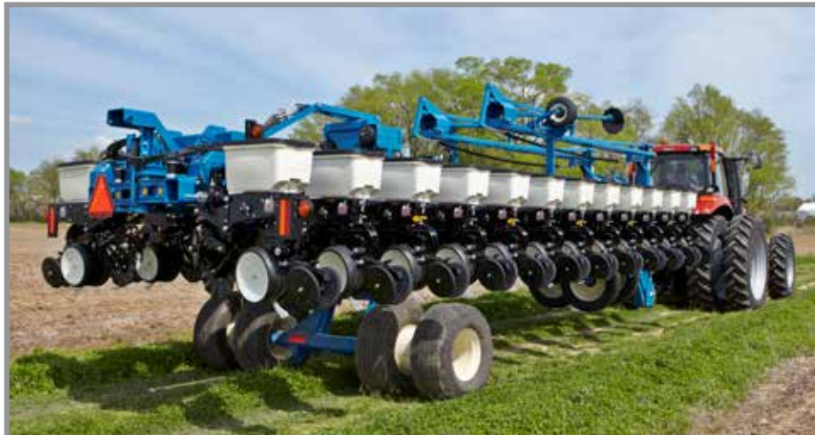
24-рядная сеялка точного высева модели 3700 со стандартными бункерами
