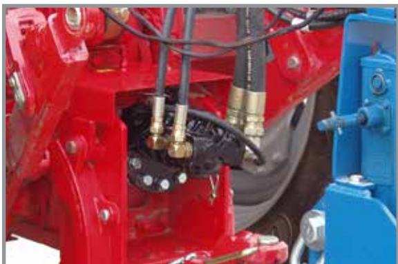
Двухсекционный гидравлический насос с приводом от ВОМ
