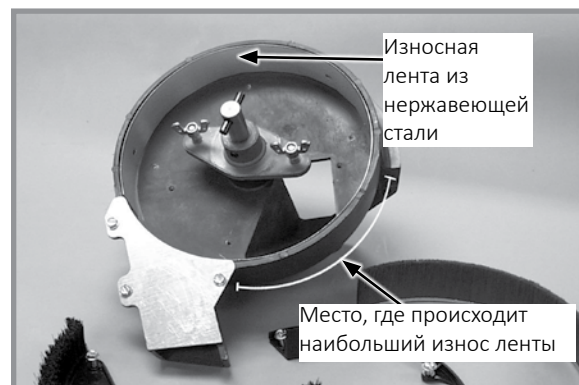
Износная лента из нержавеющей стали
