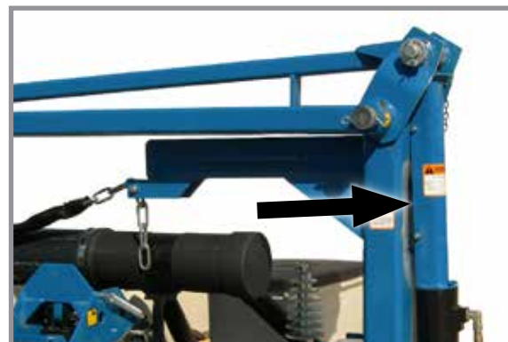
Стопорное устройство маркера установлено
