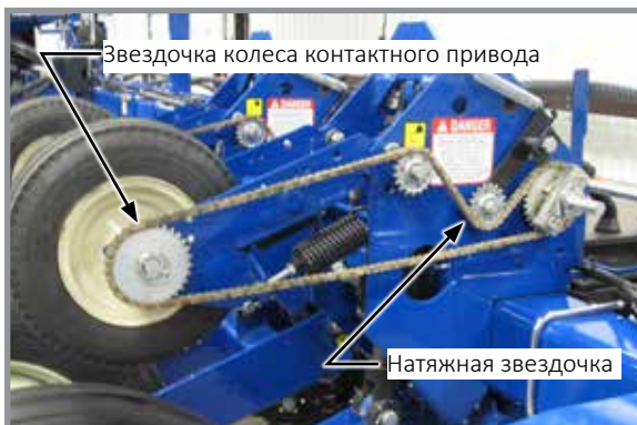
Привод от контактного колеса
