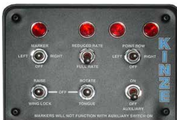
Пульт управления для системы с двухскоростной муфтой отключения указательного ряда
