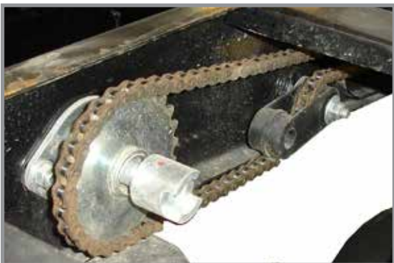
Привод высевающей секции для внесения гранулированных химикатов
