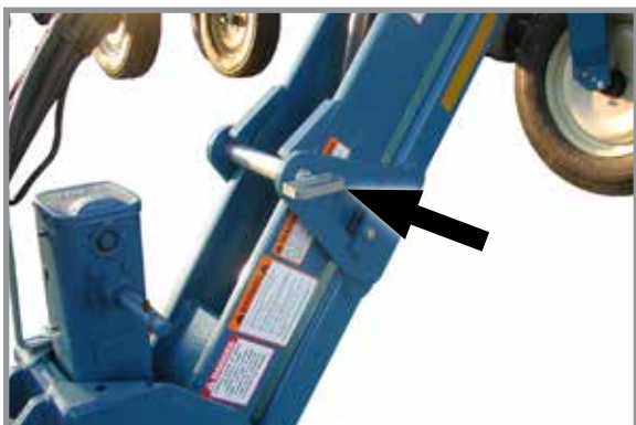
Стопорное устройство параллельных тяг дышла в установленном положении
