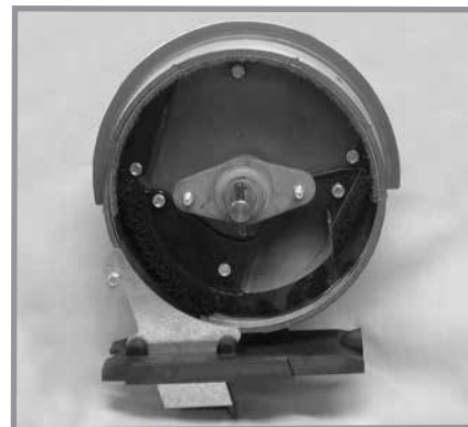
Показана сеялка без установленного высевающего диска
