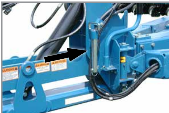
Стопорное устройство параллельных тяг дышла в положении для хранения
