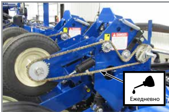
Цепи привода от контактного колеса
