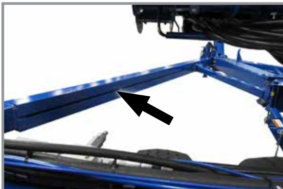
Желоб внутренней передвижной тяги (показана левая сторона)
