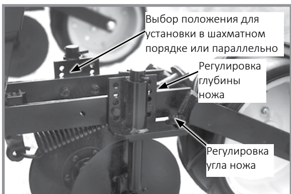
Регулировка заделывающих дисков
