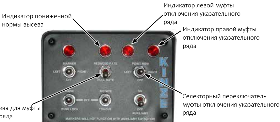
Пульт управления для системы с двухскоростной муфтой отключения указательного ряда
