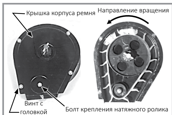
Натяжной ролик ремня
