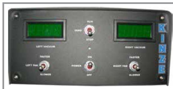
Пульт управления вакуумной системой с цифровым индикатором
