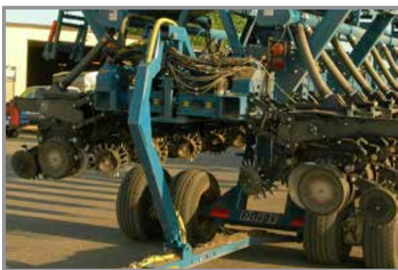
Сцепное устройство для прицепа
