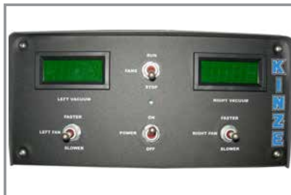
Пульт управления вакуумной системой с цифровым индикатором
