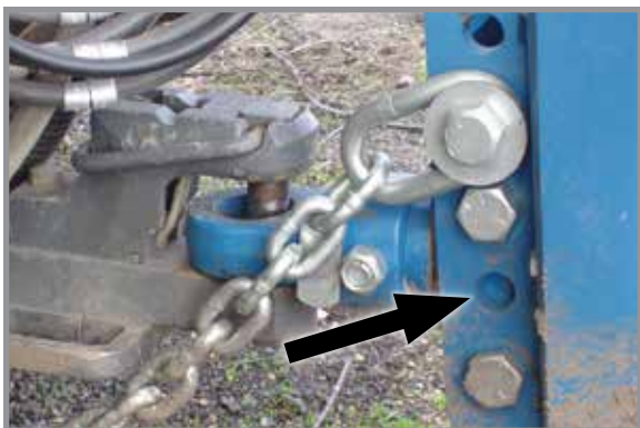
Отверстия для регулировки высоты серьги
