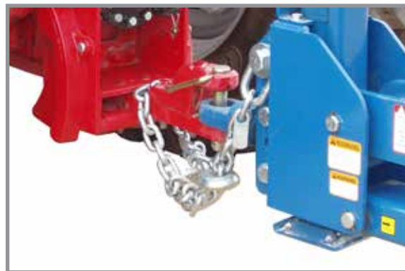
Присоединение предохранительной цепи к трактору
