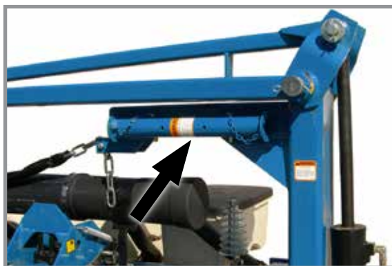
Стопорное устройство маркера в положении для хранения
