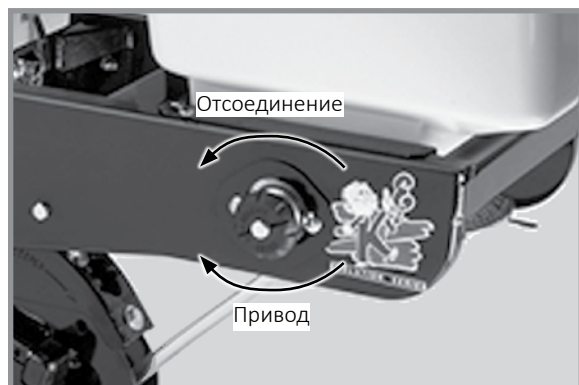
Отсоединение привода для внесения гранулированных химикатов
