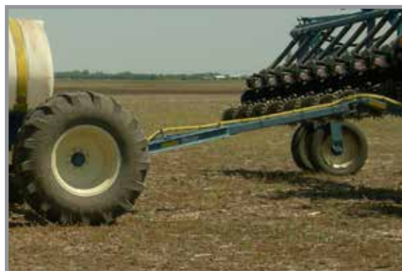
Положение сцепного устройства во время подъема
