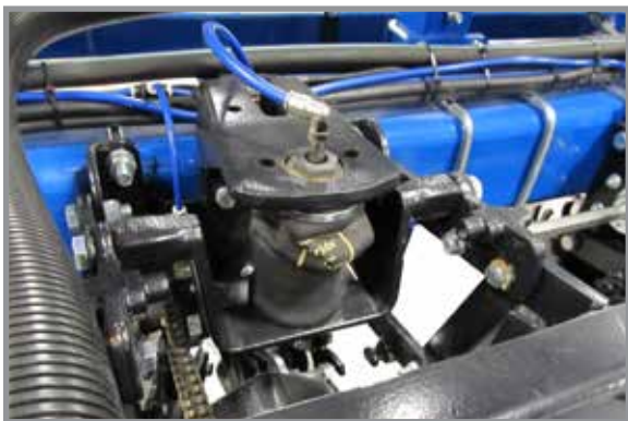
Пневмопружина пружина задней высевающей секции
