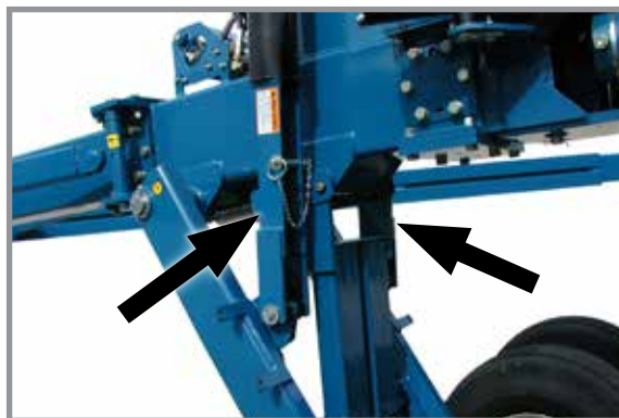
Стопорные устройства в положении для транспортировки
