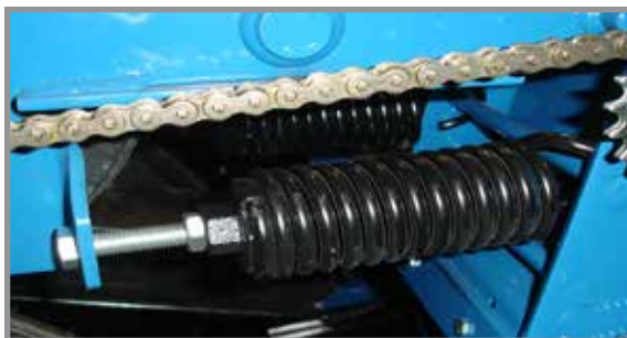
Пружины привода от контактного колеса
