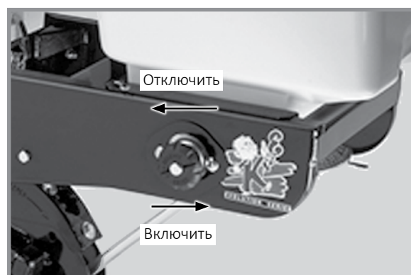
Выжимная рукоятка привода оборудования для гранулированных химикатов
