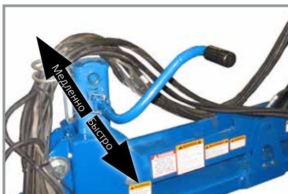
Ручка домкрата в установленном положении
