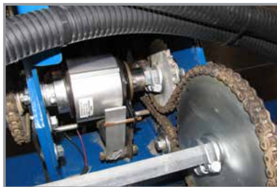
Муфта отключения указательного ряда
