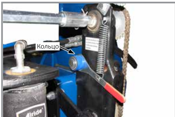
Рычаг с витой пружиной (показан левый рычаг)
