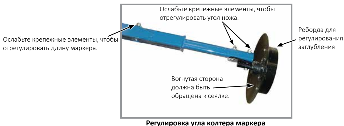
Регулировка угла колтера маркера
