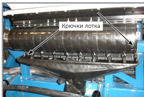
Установленный очистной лоток
