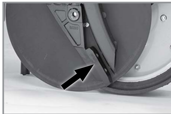
Защита семяпровода/внутренний чистик (копирующее колесо/дисковый нож сошника для внесения семян снят)
