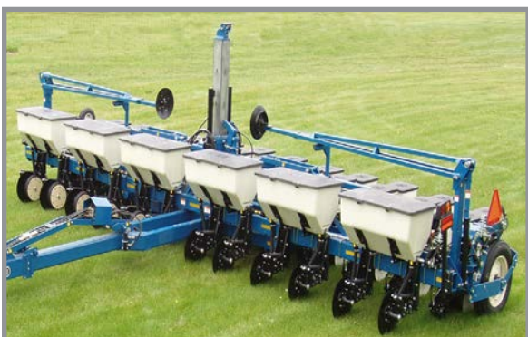
Установленное дополнительное оборудования для сухих удобрений
