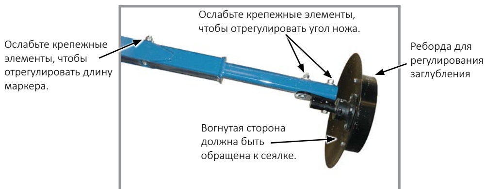
Регулировка угла дискового ножа маркера
