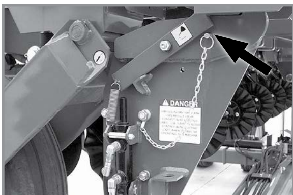
Стопорный штифт транспортировочного фиксатора Заблокированное транспортировочное положение
