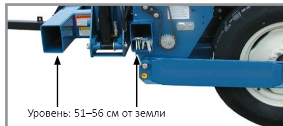
Выравнивание рам сеялки
