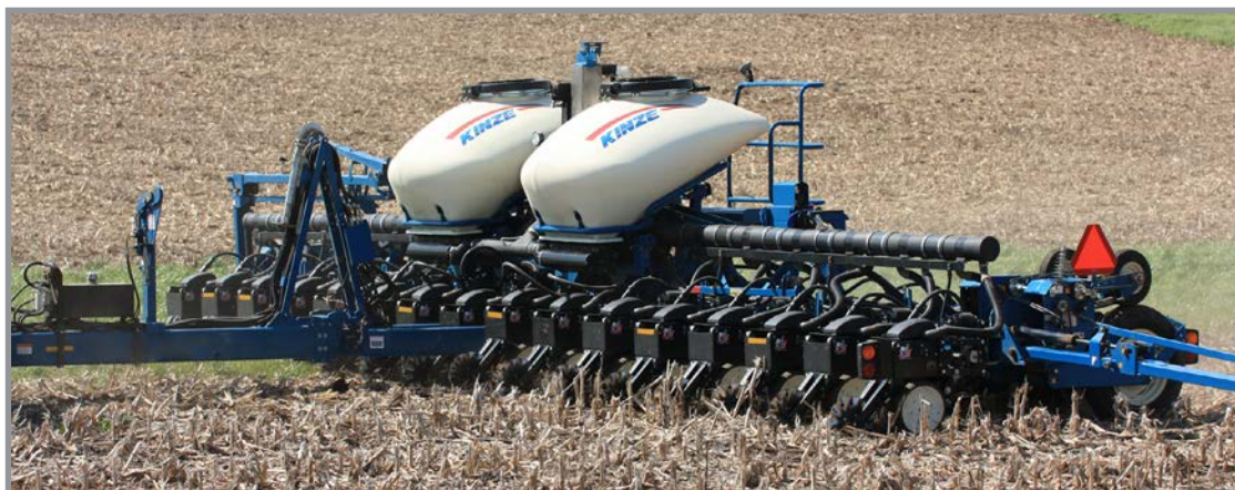
16-рядная сеялка модели 3605 с вакуумным высевальным аппаратом, раздельным высевом и системой центральных бункеров
