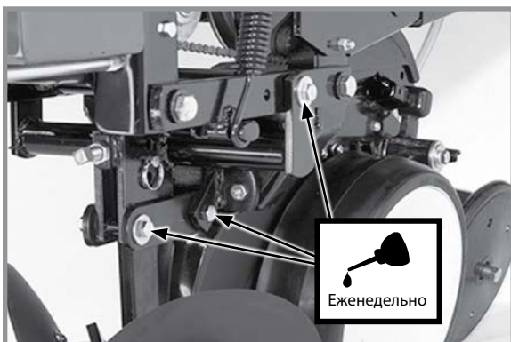
Параллелограммное навесное устройство дискового борозделателя с креплением на высевающей секции (по 6 точек смазки на ряд)
