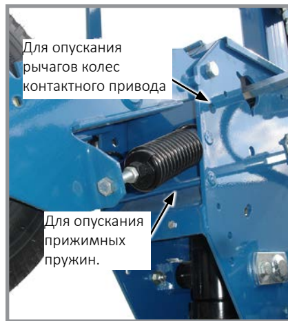
Регулировка колес контактного привода
