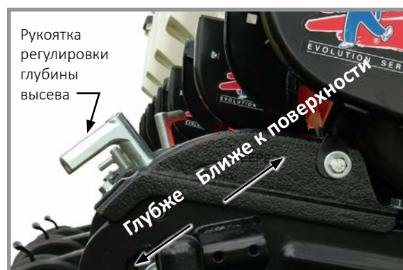
Регулировка глубины высева
