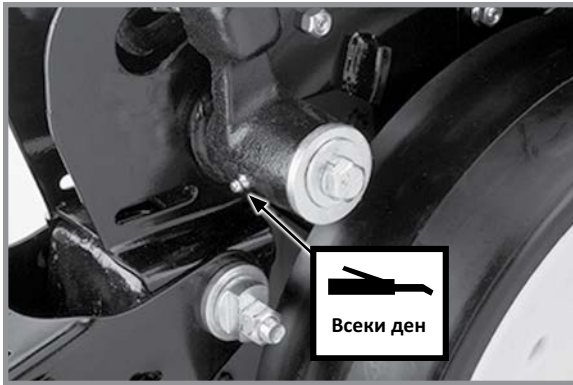
Рамена на габаритно колело - 1 на рамо (Уплътненията при рамото на габаритното колело се монтират с улея навън, за да може смазката да почисти замърсяванията от уплътнението. Изпомпвайте смазката към рамото до появата на нова смазка между шайбите и рамото.)
