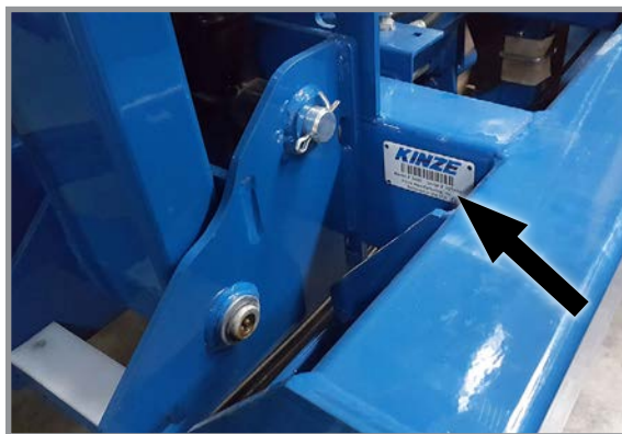
Местоположение на пластината със серийен номер - външно дясно крило (Производство през 2021 г. и след това)
