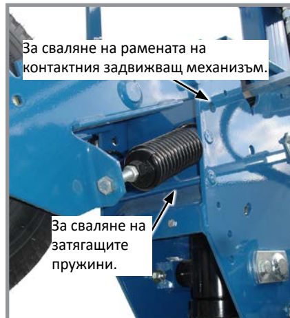
Регулиране на колела на контактния задвижващ механизъм
