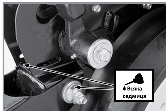
V-образно затварящо колело на сееща секция и/ или ексцентрикови втулки на затварящо колело за зариване на бразди (2 точки на смазване на сееща секция)
