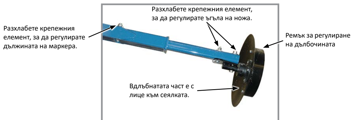
Регулиране на ъгъла на дисковия нож на маркера
