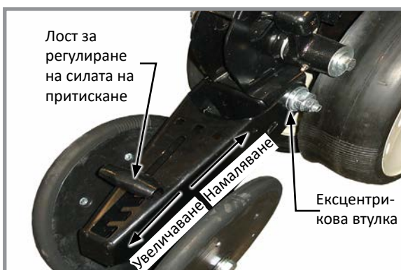
Регулиране на V-образните натискателни ролки
