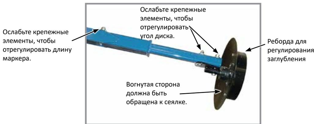
Регулировка угла колтера маркера
