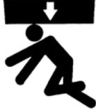
Падение оборудования может привести к серьезным травмам, в том числе с летальным исходом. Перед началом работы на оборудовании установите все устройства блокировки или опустите сеялку на уровень земли.
