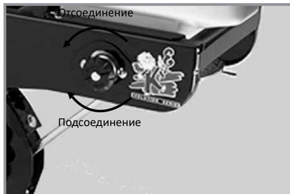
Отсоединение привода для внесения гранулированных удобрений
