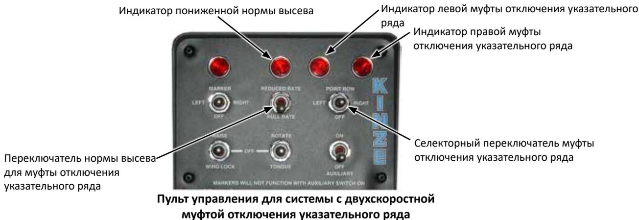
Управление муфтами отключения указательного ряда осуществляется с помощью переключателей муфт отключения указательного ряда, расположенных на пульте управления. Переключатель указательного ряда выключает левую или правую сторону сеялки. Активация переключателя пониженной нормы высева приводит в действие один электромагнитный клапан на каждой муфте и снижает норму высева для всей сеялки.
