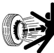
Взрыв шины может привести к серьезным травмам, в том числе с летальным исходом. Причиной взрыва шины может стать избыточное давление в шине, выполнение работ на колесном диске или шине, неправильное использование колесных дисков и шин, использование изношенных или неправильно обслуживаемых шин.
