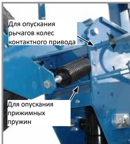
Регулировка колес контактного привода
