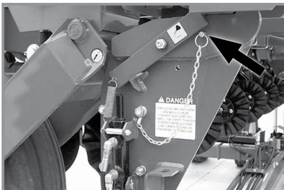
Стопорный штифт транспортировочного фиксатора
