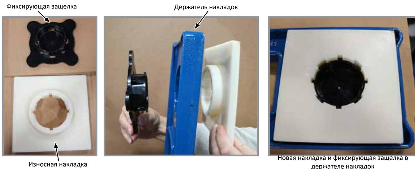
8. Установите новую накладку с помощью фиксирующей защелки. Повторите с другой стороны держателя накладок.
