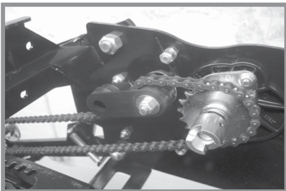
Привод механического высевающего аппарата фронтальной высевающей секции
