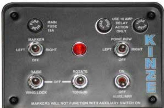
Пульт управления для системы с односкоростной муфтой отключения указательного ряда
