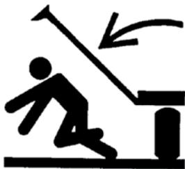
Всегда устанавливайте стопорные устройства маркеров при эксплуатации или транспортировке сеялки.
