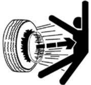
Взрыв шины может привести к серьезным травмам, в том числе с летальным исходом. Причиной взрыва шины может стать избыточное давление в шине, выполнение работ на колесном диске или шине, неправильное использование колесных дисков и шин, использование изношенных или неправильно обслуживаемых шин.
