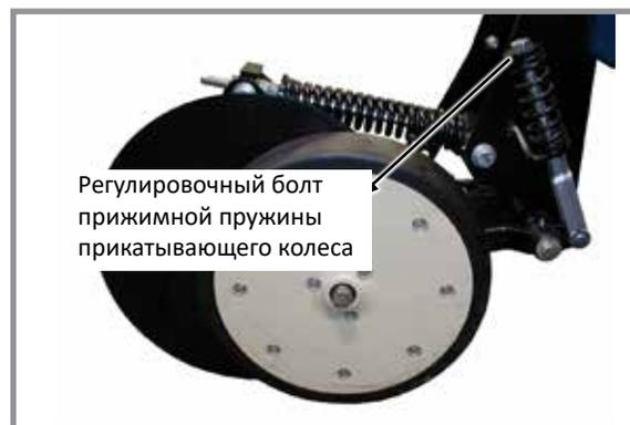
Регулировочный болт прижимной пружины прикатывающего колеса
