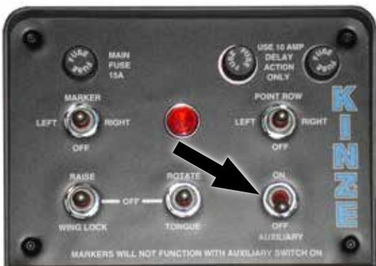
Переключатель дополнительной функции
