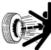
Ослабление болтов крепления транспортного колеса может привести к отсоединению колеса от сеялки и может стать причиной серьезных травм, в том числе с летальным исходом, порчи имущества или повреждения оборудования. Перед вводом сеялки в эксплуатацию, а также периодически после этого подтягивайте болты ( $\frac{5}{8}$  - 18) транспортного колеса моментом 244 Н·м.
