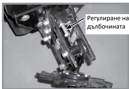
Регулиране на дълбочината на колелото
