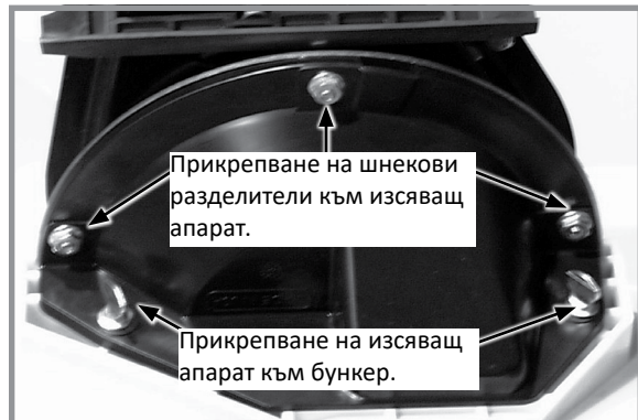
Сваляне на изсяващ апарат и шнеков разделител
