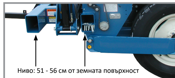
Нивелиране на рамата за инструменти на сеялката
