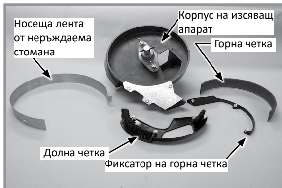
Части на изсяващ апарат тип четка
