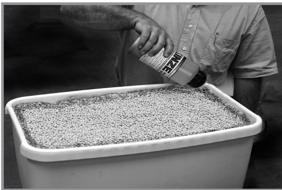
Добавяне на графит към стандартен бункер
