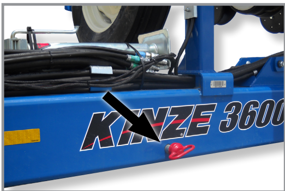
Монтиран предпазен щифт на теглич за транспортиране
