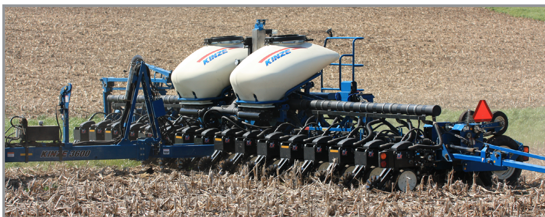
16-редове сеялка за точна сеитба, модел 3600, с вакуумна система, система Interplant и система за зареждане на насипни материали.
