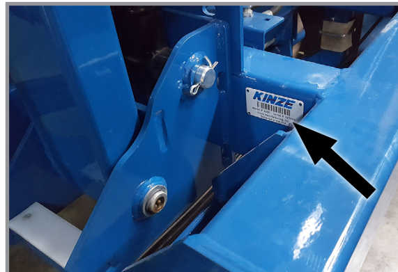
Местоположение на пластината със серийен номер - външно дясно крило (Производство през 2019 г. и след това)
