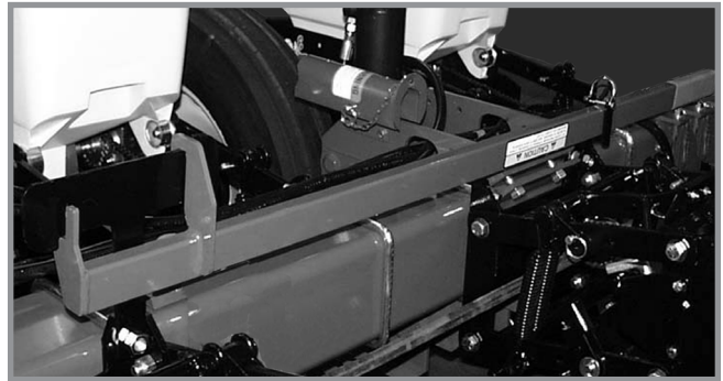
Лост за повдигане в позиция за съхранение
