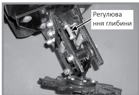
Регулювання глибини колеса
