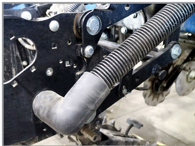
Відключення вакуумного шланга роздільного висіву
