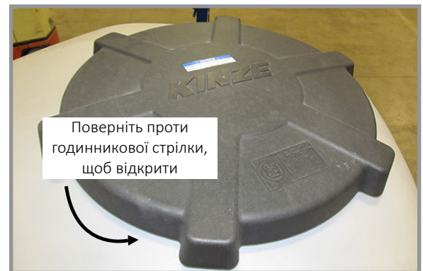
Кришка резервуара центрального бункера
