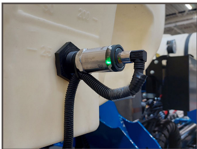
Датчик на баку для добрив
