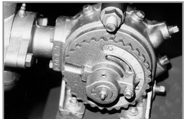
Поршневий насос для рідких добрив
