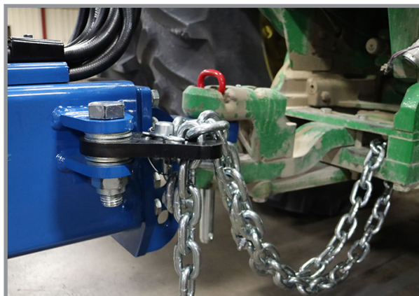
З'єднання тягового бруса і запобіжного ланцюга
