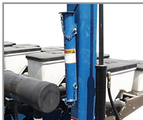
Блокувальний пристрій в положенні для зберігання
