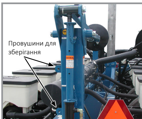
Встановлений блокувальний пристрій маркера
