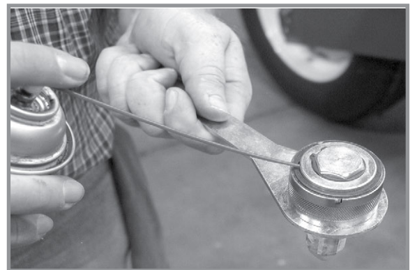
Мастило важеля з витою пружиною
