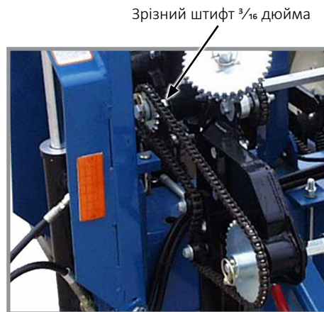
Привід системи внесення сухих добрив
