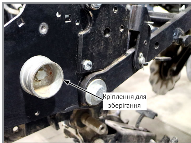
Відключення вакуумного шланга роздільного висіву
