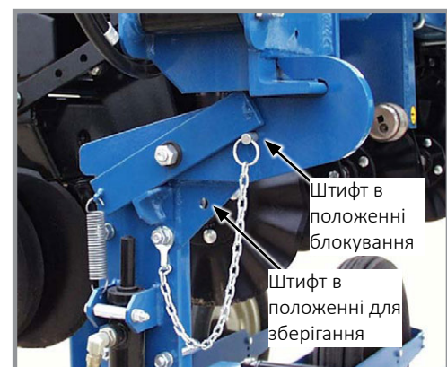
Місця встановлення блокувального штифта транспортного фіксатора
