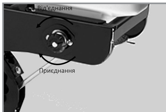
Розчіпний пристрій приводу для гранульованих хімікатів
