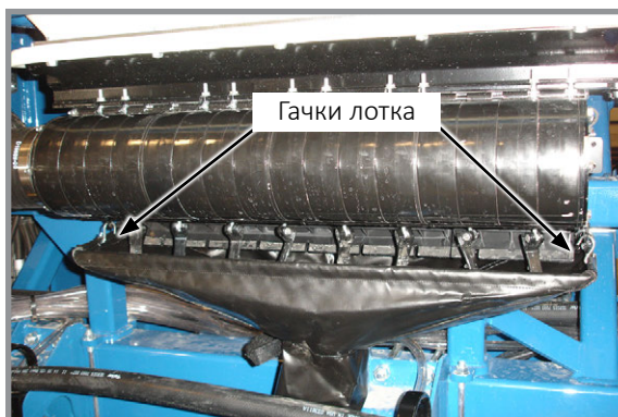
Встановлений очисний лоток
