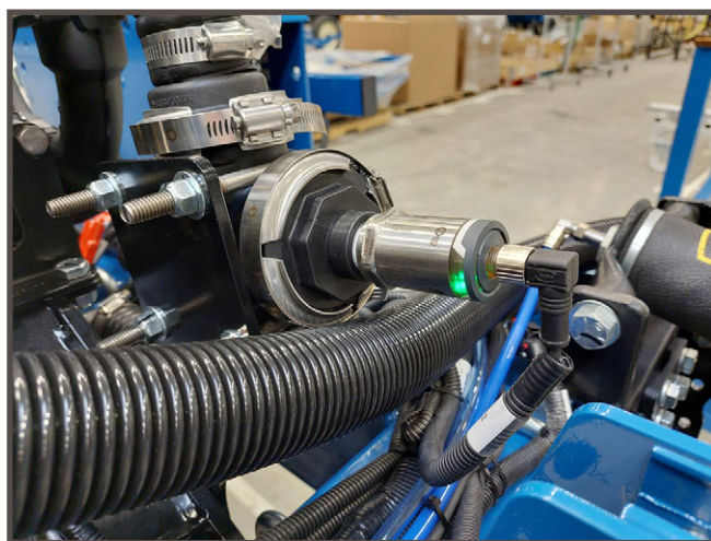
Датчик на проточній лінії насоса
