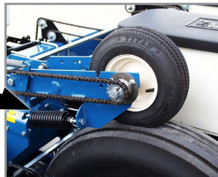
Розташування притисної пружини
