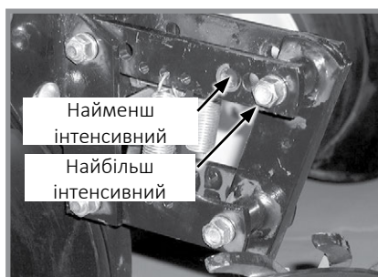
Регулювання кута повороту колеса
