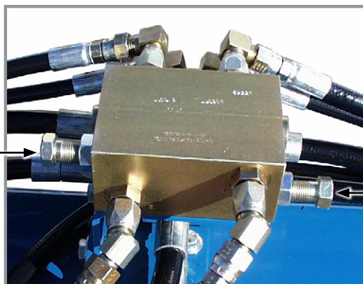
Клапан регулювання витрати маркерів
