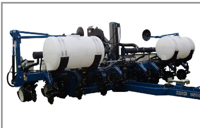
Встановлене додаткове обладнання для рідких добрив
