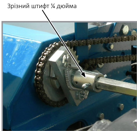
Привід системи внесення рідких добрив
