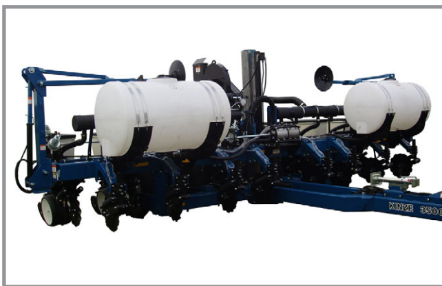
Установленное дополнительное оборудования для жидких удобрений
