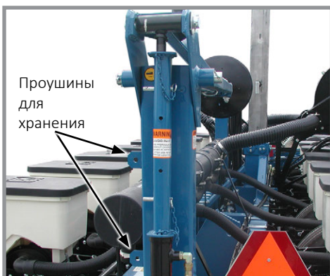
Установленное стопорное устройство маркера
