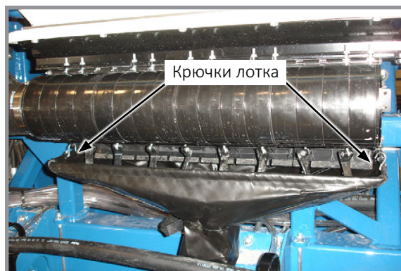
Установленный очистной лоток
