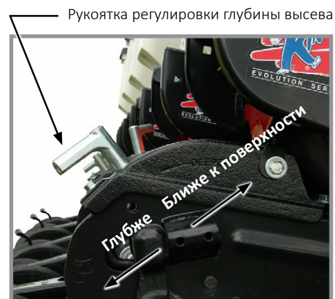
Регулировка глубины высева
