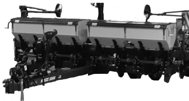
Установленное дополнительное оборудование для сухих удобрений
