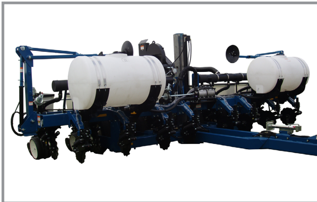
Opțiunea pentru îngrășământ lichid instalată
