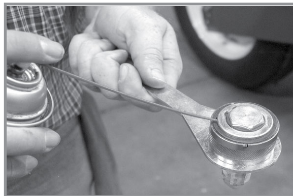
Lubrifierea cheii de tensionare a arcului
