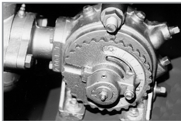
Pompa cu piston pentru îngrășământ lichid
