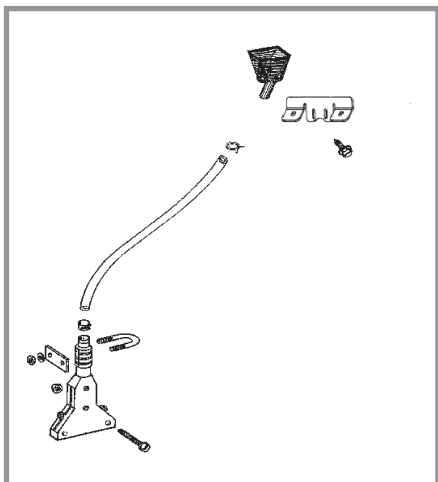
Întinzător cu compensarea pantei de 4½" (~11 cm)
