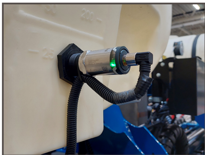
Senzor pe rezervorul de îngrășământ
