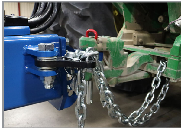
Свързване на теглич и предпазна верига
