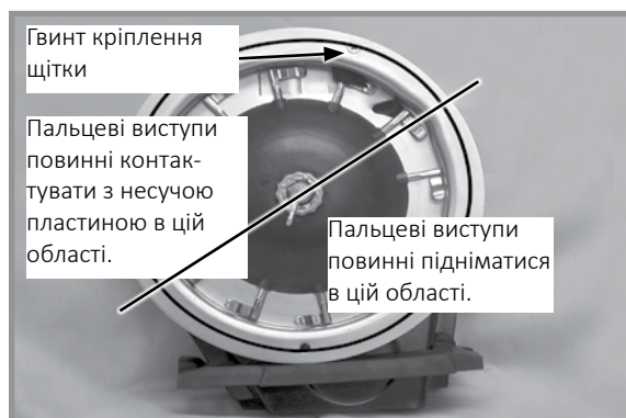
Правильна робота пальчикового висівного апарату
