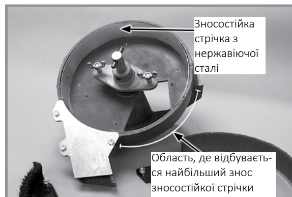
Зносостійка стрічка з нержавіючої сталі
