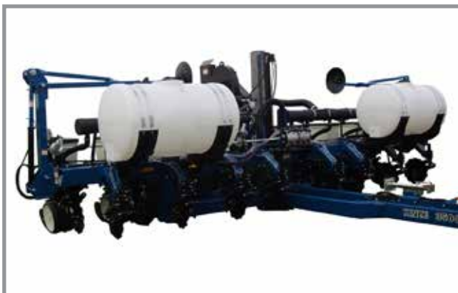
Встановлене додаткове обладнання для рідких добрив
