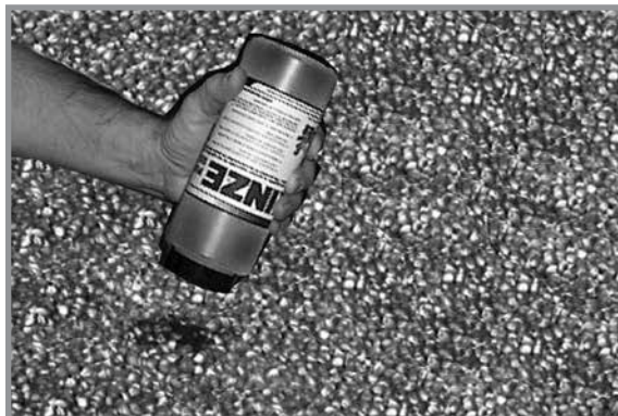
Додавання графіту в центральний бункер для насіння
