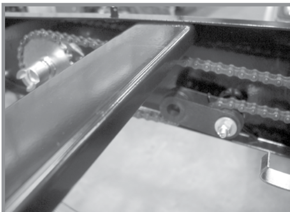
Привід висівної секції для внесення гранульованих добрив
