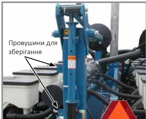
Встановлений блокувальний пристрій маркера
