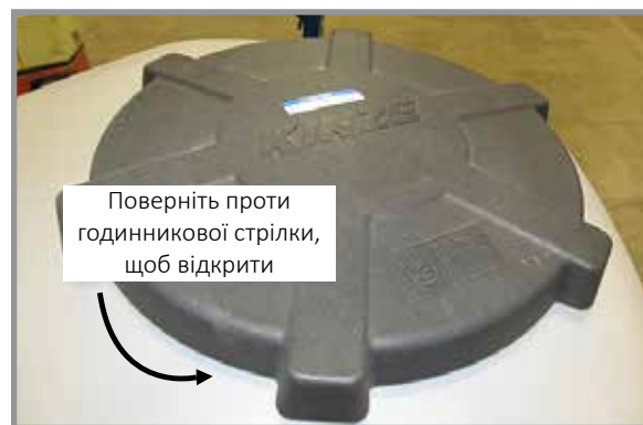
Кришка резервуара центрального бункера
