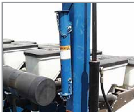
Блокувальний пристрій в положенні для зберігання
