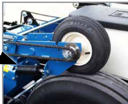
Розташування притисної пружини
