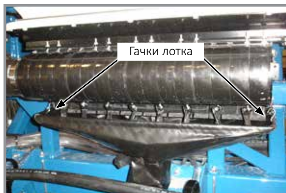
Встановлений очисний лоток
