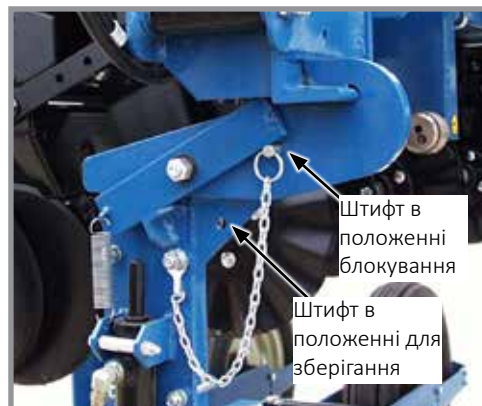
Місця встановлення блокувального штифта транспортувального фіксатора
