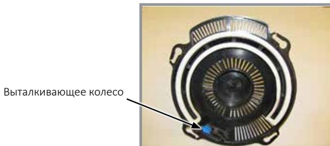
**ЗАМЕЧАНИЕ.** Использование поврежденных семян или семян, содержащих посторонние материалы, вызывает закупоривание отверстий высевающего диска. Для предотвращения отклонения нормы высева требуется более частая очистка высевающего аппарата.
