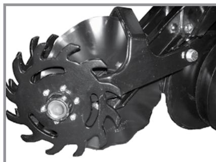
Колеса для пожнивных остатков фиксируются на дисковых ножах, устанавливаемых на высевающей секции, с помощью двух винтов с шестигранными головками и втулок, что обеспечивает плавающее перемещение узла. Болт оси имеет два положения, соответствующие блокировке колес или расположению в шахматном порядке. Регулировка глубины осуществляется с помощью подпружиненного кулачка и штифта, устанавливаемых в одно из 11 положений с шагом ~6 мм. Выступ на кулачке обеспечивает фиксацию колес.
