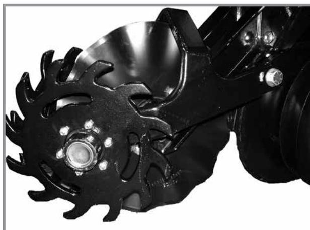
Ступицы колес оснащены герметизированными подшипниками. Замените подшипник, если при вращении колеса подшипник чрезмерно шумит или вращается с заеданиями.
