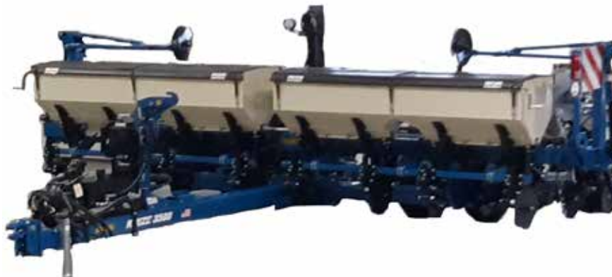
Модел 3500 със стандартни бункери и резервоари за сух тор
