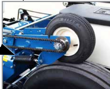
Местоположение на затягащата пружина
