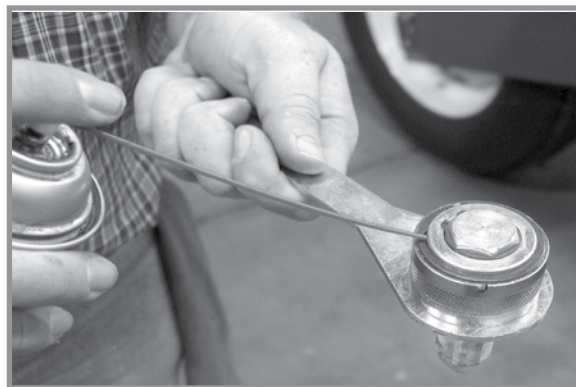
Смазване на ключ за навита пружина
