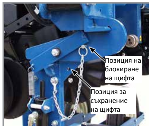
Позиции на блокиращия щифт на транспортния фиксатор
