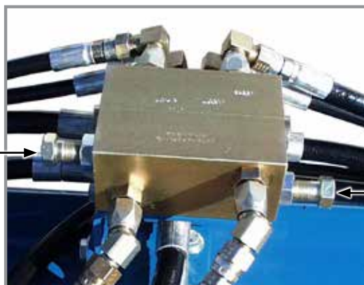
Клапани за контрол на дебита на маркера
