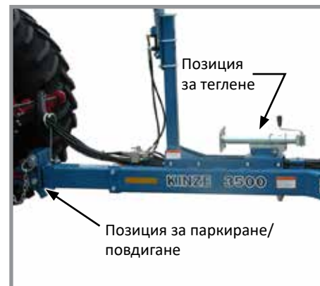
Позиции на подемна опора
