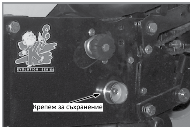
Спиране на вакуумен маркуч на система за разделяне на редовете
