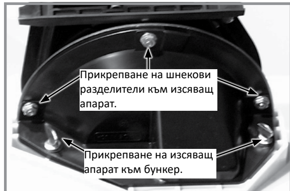
Сваляне на изсяващ апарат и шнеков разделител
