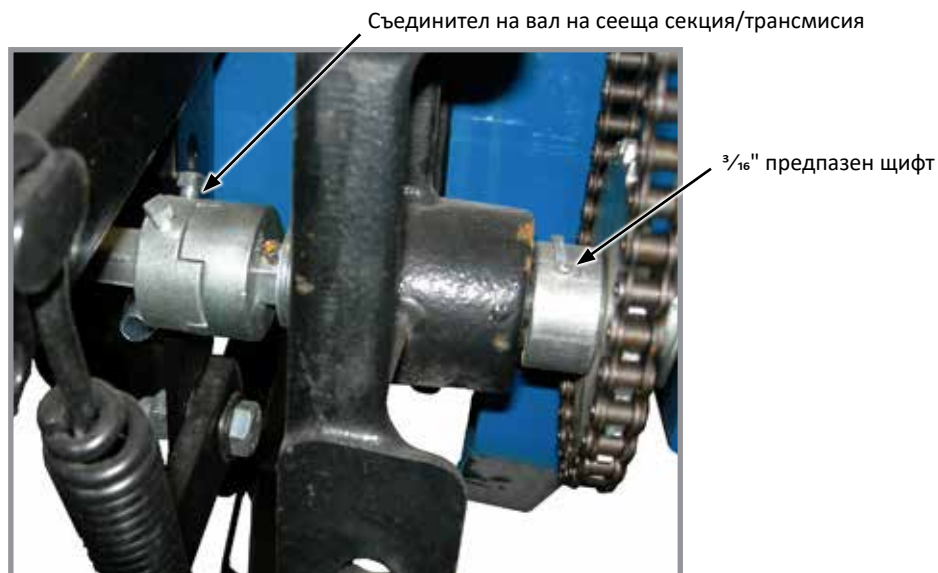
Соединител на вал на трансмисия и вал на сееща секция
