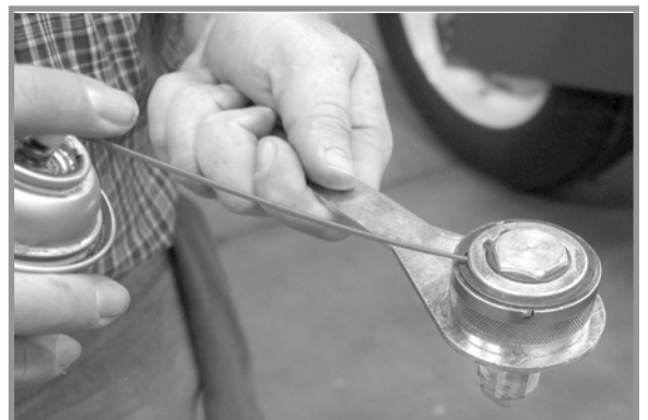
Lubrifierea cheii de tensionare a arcului
