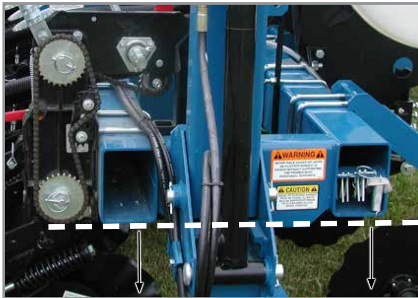
Partea inferioară a barelor de unelte 20" - 22" (~51- 56 cm) față de suprafața de plantare
