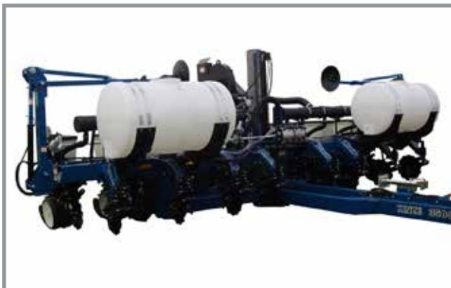
Opțiunea pentru îngrășământ lichid instalată
