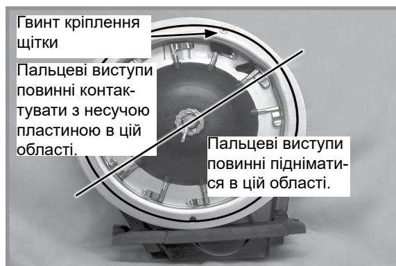
Правильна робота пальчикового висівного апарату
