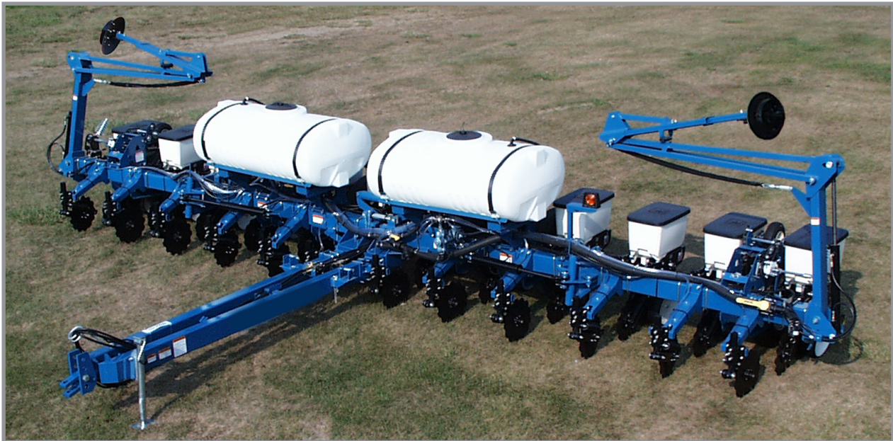
Встановлене додаткове обладнання для рідких добрив
