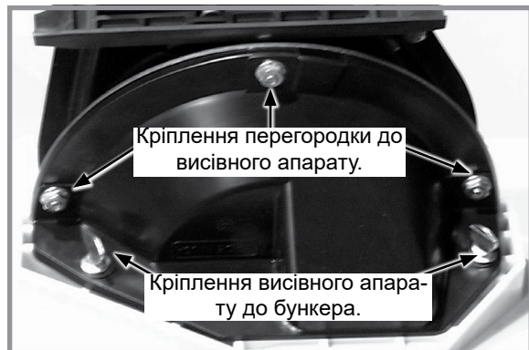
Зняття висівного апарату та перегородки
