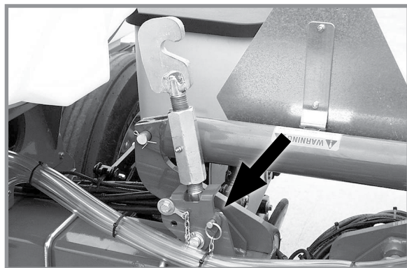
Стопорный штифт центральной стяжной винтовой муфты
