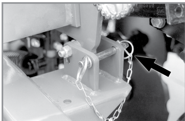
Предохранительный штифт крыла в положении для транспортировки
