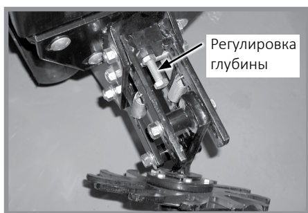
Регулировка глубины колес
