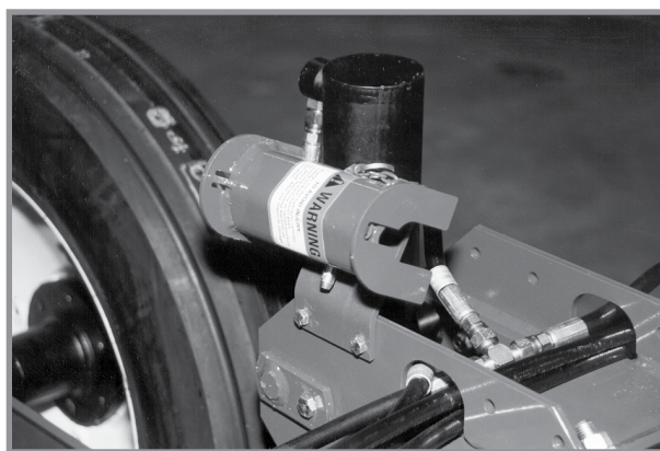
Блокировочное устройство подъемного цилиндра в положении для хранения
