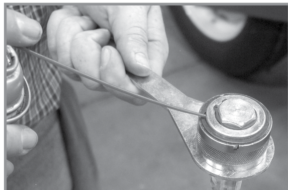
Смазка рычага с витой пружиной
