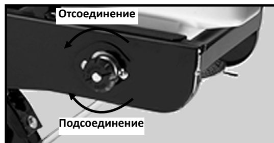
Отсоединение привода для внесения гранулированных химикатов
