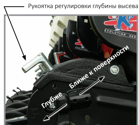
Регулировка глубины высева
