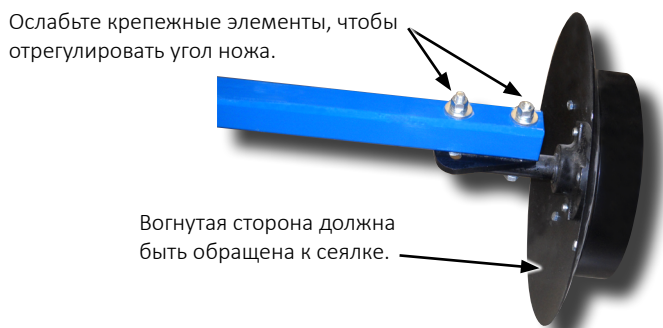
Регулировка угла дискового ножа маркера
