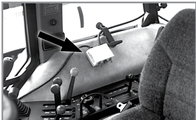
Пульт управления муфтой отключения указательного ряда
