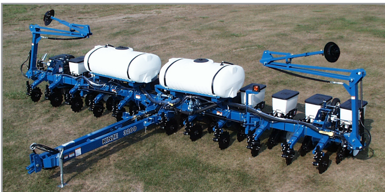
Установленное дополнительное оборудования для жидких удобрений
