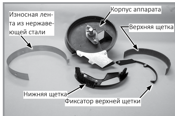
Детали щеточного высевающего аппарата
