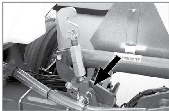
Стопорный штифт центральной стяжной винтовой муфты
