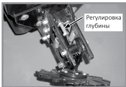
Регулировка глубины колес
