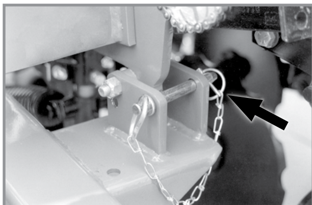
Предохранительный штифт крыла в положении для транспортировки
