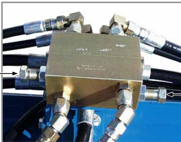
Клапаны регулировки расхода маркеров
