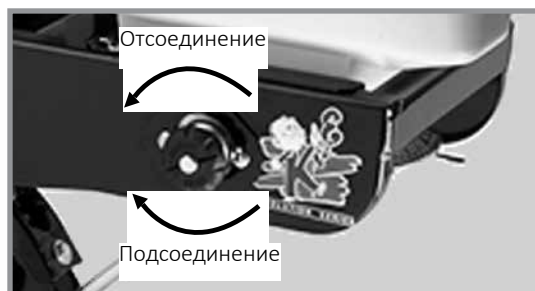
Отсоединение привода для внесения гранулированных химикатов
