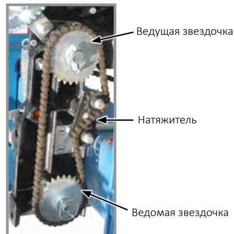
Натяжение цепи привода трансмиссии нормы высева
