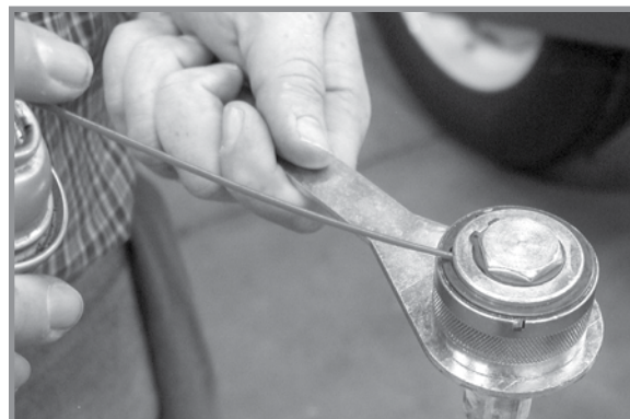
Смазка рычага с витой пружиной
