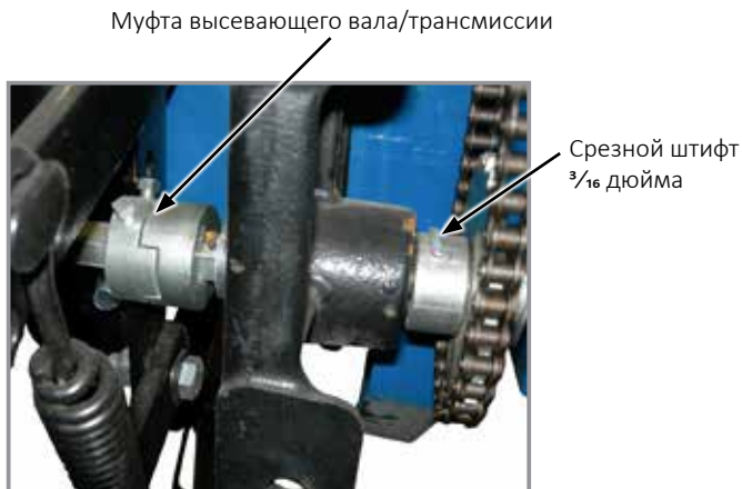
Муфта вала трансмиссии и приводного вала высевяющих аппаратов
