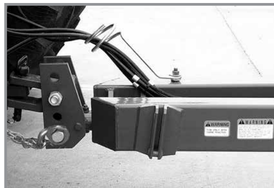
Соединение тягового бруса и предохранительной цепи
