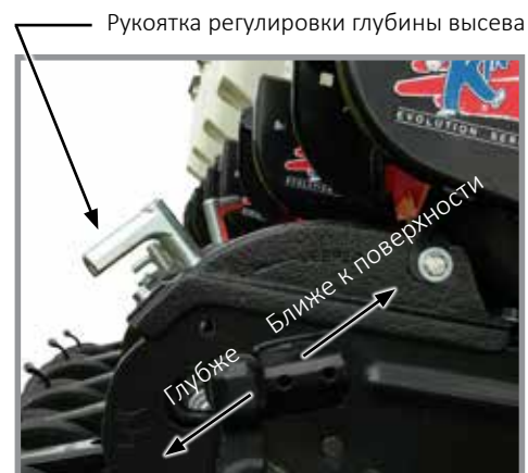
Регулировка глубины высева
