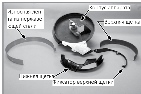
Детали щеточного высевающего аппарата
