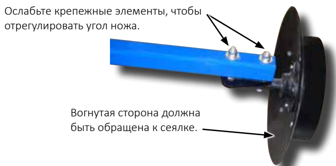
Регулировка угла дискового ножа маркера
