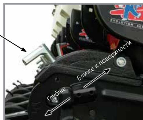
Регулировка глубины высева
