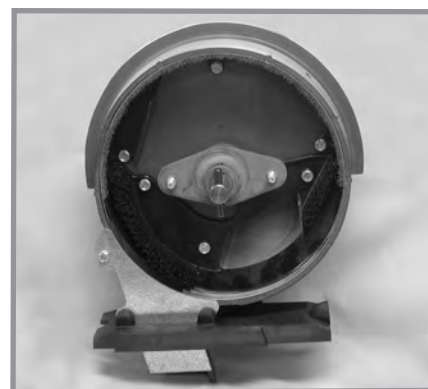
Показана сепалка без установленного высевающего диска
