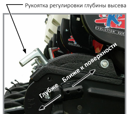
Регулировка глубины высева
