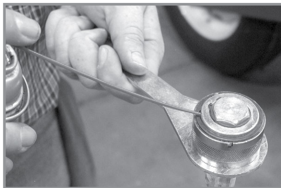
Смазка рычага с витой пружиной
