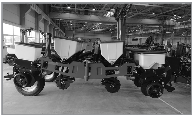
Установленное дополнительное оборудования для сухих удобрений
