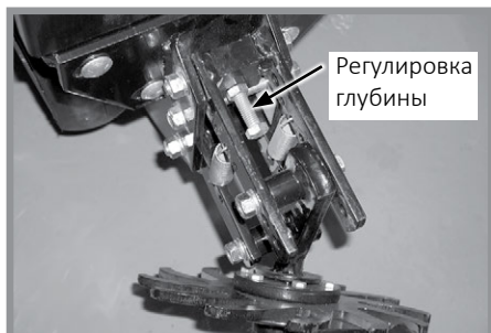
Регулировка глубины колес
