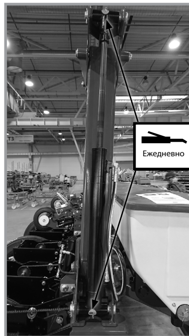
Показана 8-рядная сеялка точного высева модели 3035 с междурядьем 70 см
