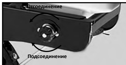
Отсоединение привода для внесения гранулированных удобрений
