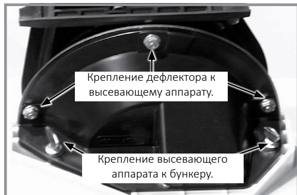
Снятие высевающего аппарата и дефлектора
