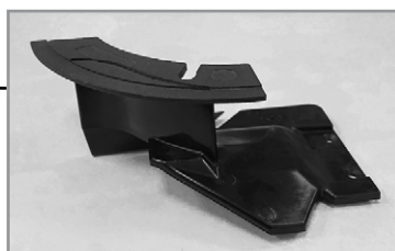
Место прокладки на дефлекторе
