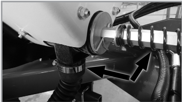
Отсоедините приводной вал и шланги
