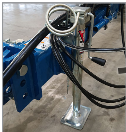
Домкратная стойка в установленном положении
