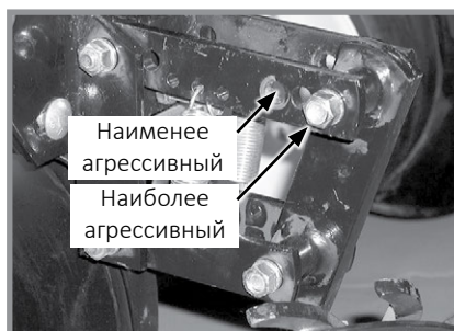
Регулировка угла колес
