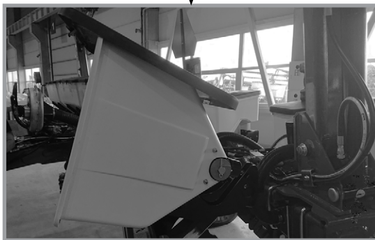
Поверните крышку назад и поверните бункер вперед
