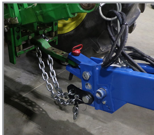
Соединение тягового бруса и предохранительной цепи
