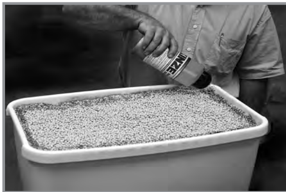
Добавление графита в стандартный бункер
