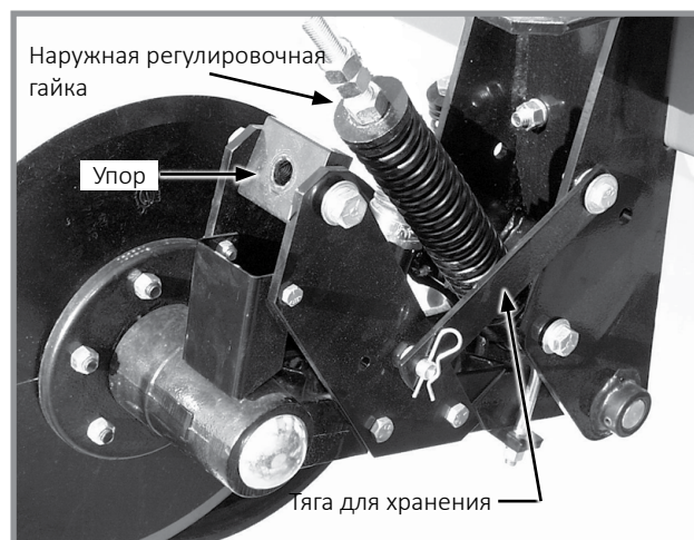
Блокировка усиленного однодискового сошника
