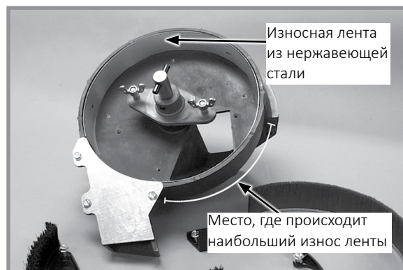
Износная лента из нержавеющей стали
