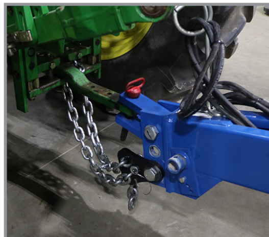
Свързване на теглич и предпазна верига
