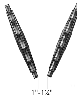
Монтирана на сеещата секция натискателната ролка с шипове
