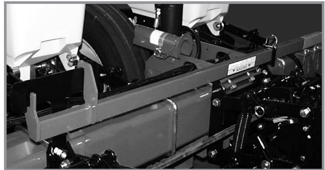
Лост за повдигане в позиция за съхранение
