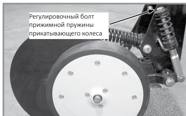
Регулировка прижима прикатывающего колеса
