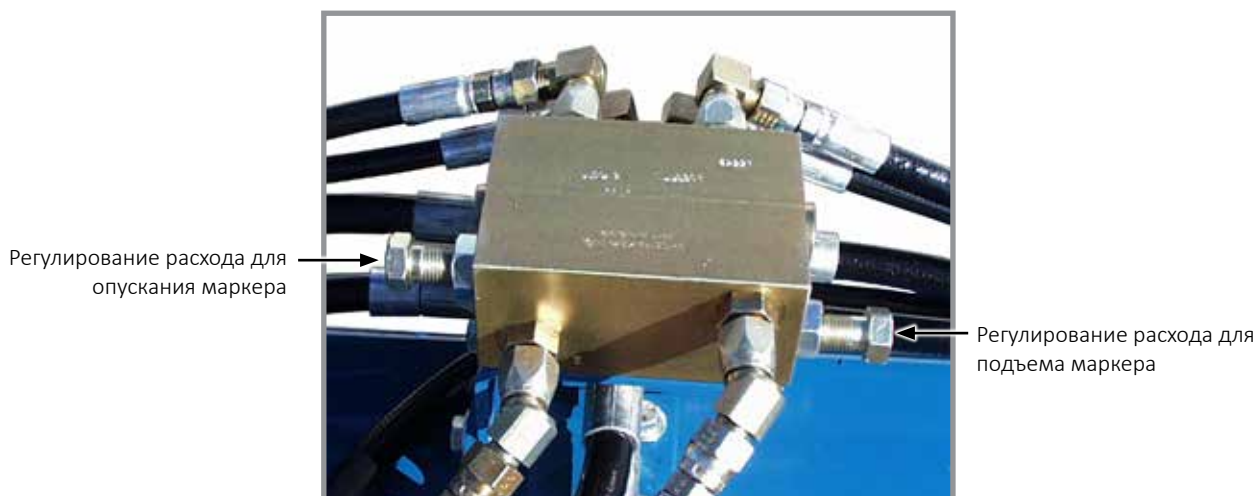
Клапаны регулировки расхода маркеров
