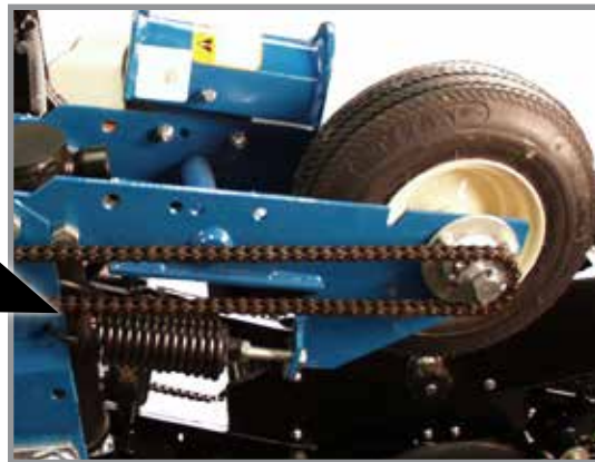
Расположение прижимной пружины
