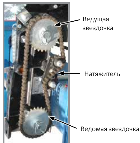
Натяжение цепи привода трансмиссии нормы высева
