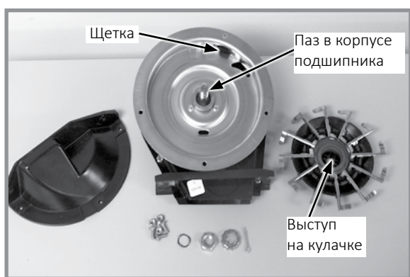
Детали пальчикового высевающего аппарата
