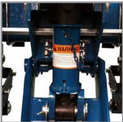
Установленное стопорное устройство
