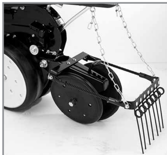
Устройство для внесения удобрений с пружинной бороной
