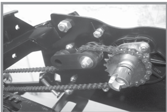
Привод механического высевающего аппарата фронтальной высевающей секции
