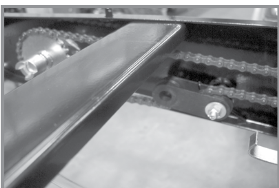
Привод высевающей секции для внесения гранулированных удобрений
