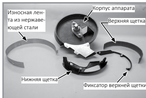
Детали щеточного высевающего аппарата
