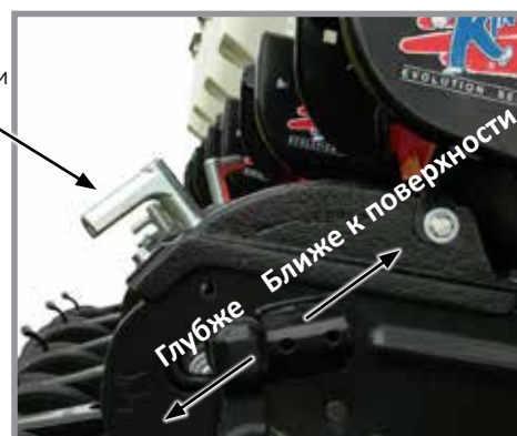
Регулировка глубины высева
