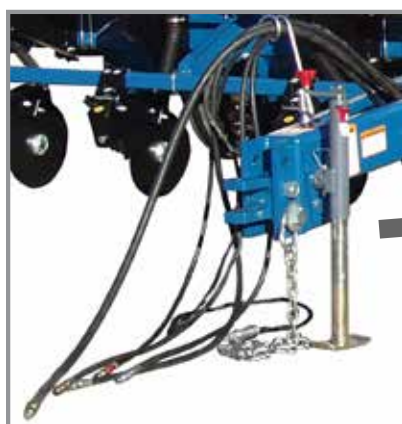
Домкратная стойка в установленном положении
