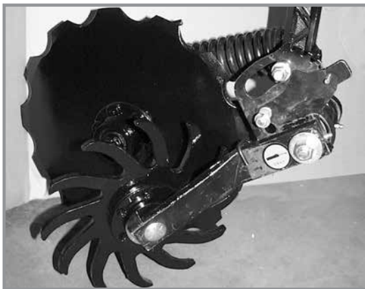
Колесо для пожнивных остатков с креплением на зубчатом однодисковом сошнике
