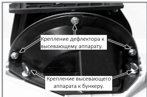
Снятие высевающего аппарата и дефлектора
