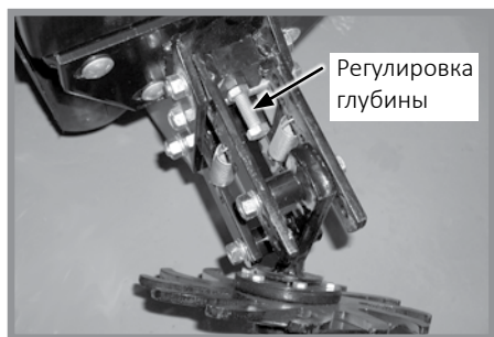
Регулировка глубины колес
