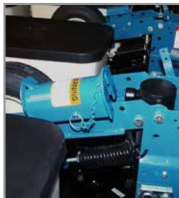
Стопорное устройство в положении для хранения
