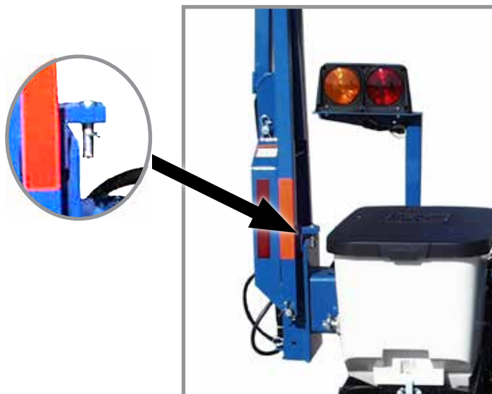
Расположение стопорного штифта рычага маркера
