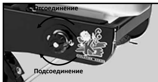
Отсоединение привода для внесения гранулированных удобрений
