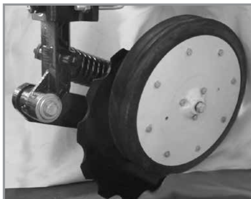
Регулятор заглубления/копирующее колесо зубчатого однодискового сошника
