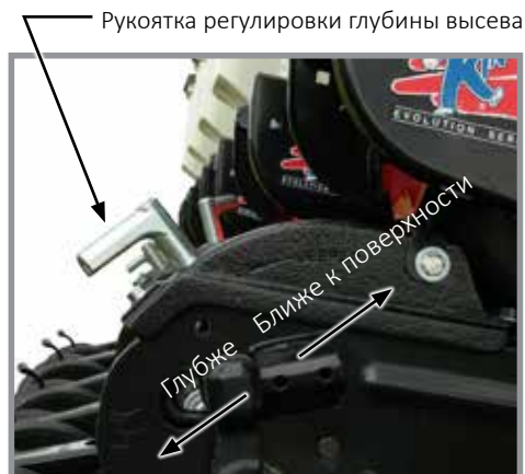
Регулировка глубины высева
