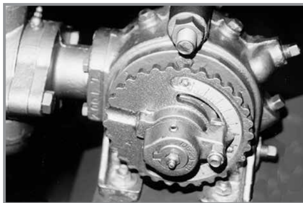
Бутална помпа за течен топ
