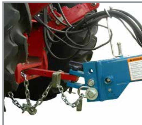
Свързване на теглич и предпазна верига
