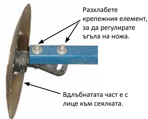
Регулиране на ъгъла на дисковия нож на маркера
