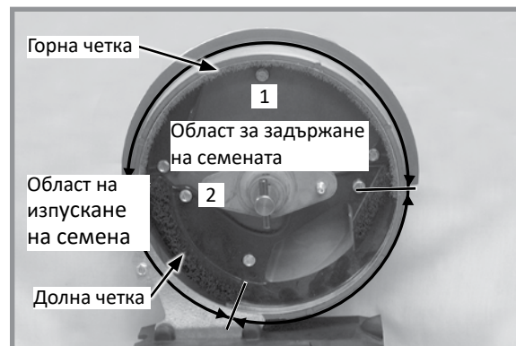
Монтиране на горна четка
