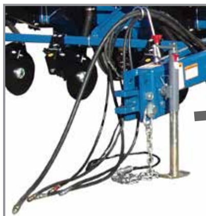
Монтирана подемна опора
