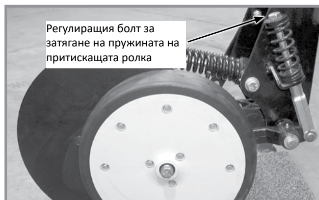
Регулиране на силата на затягане на притискащата ролка за почва
