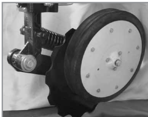
Опорно/габаритно колело на назъбен еднодисков лемеж
