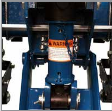
Монтирано предпазно блокиращо устройство
