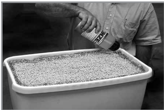
Добавяне на графит към стандартен бункер
