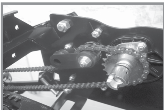
Механичен задвижващ механизъм на изсяващ апарат на предна сееща секция
