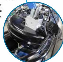
Высокоэффективный тихий вакуумный вентилятор и вакуумные шланги диаметром 1,5 дюйма, облегчающие снятие и обслуживание высевующих аппаратов
